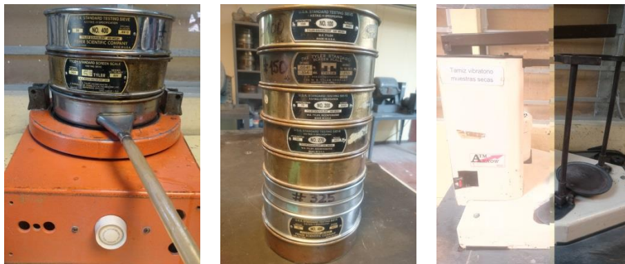
Figura 8. Equipo de deslamado y tamizado con las mallas utilizadas para el análisis de granulometría
