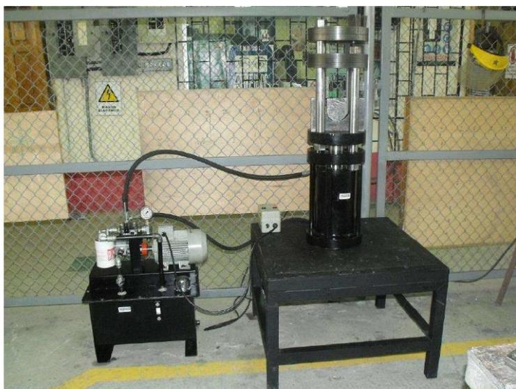
**Figura 45.** Máquina de ensayos destructivos en juntas soldadas y su sistema hidráulico
