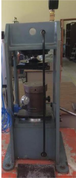
*Figura 30.* Cilindro Prensa AMSLER
