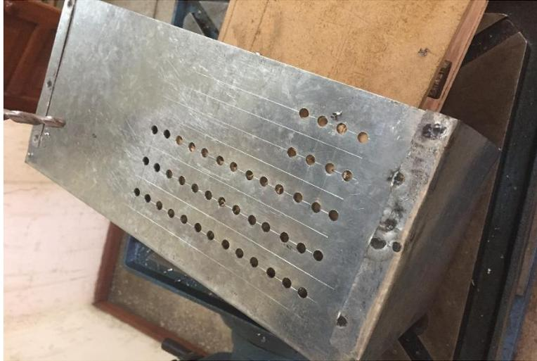
**Figura 146.** Para realizar los agujeros utilizamos un taladro radial.
