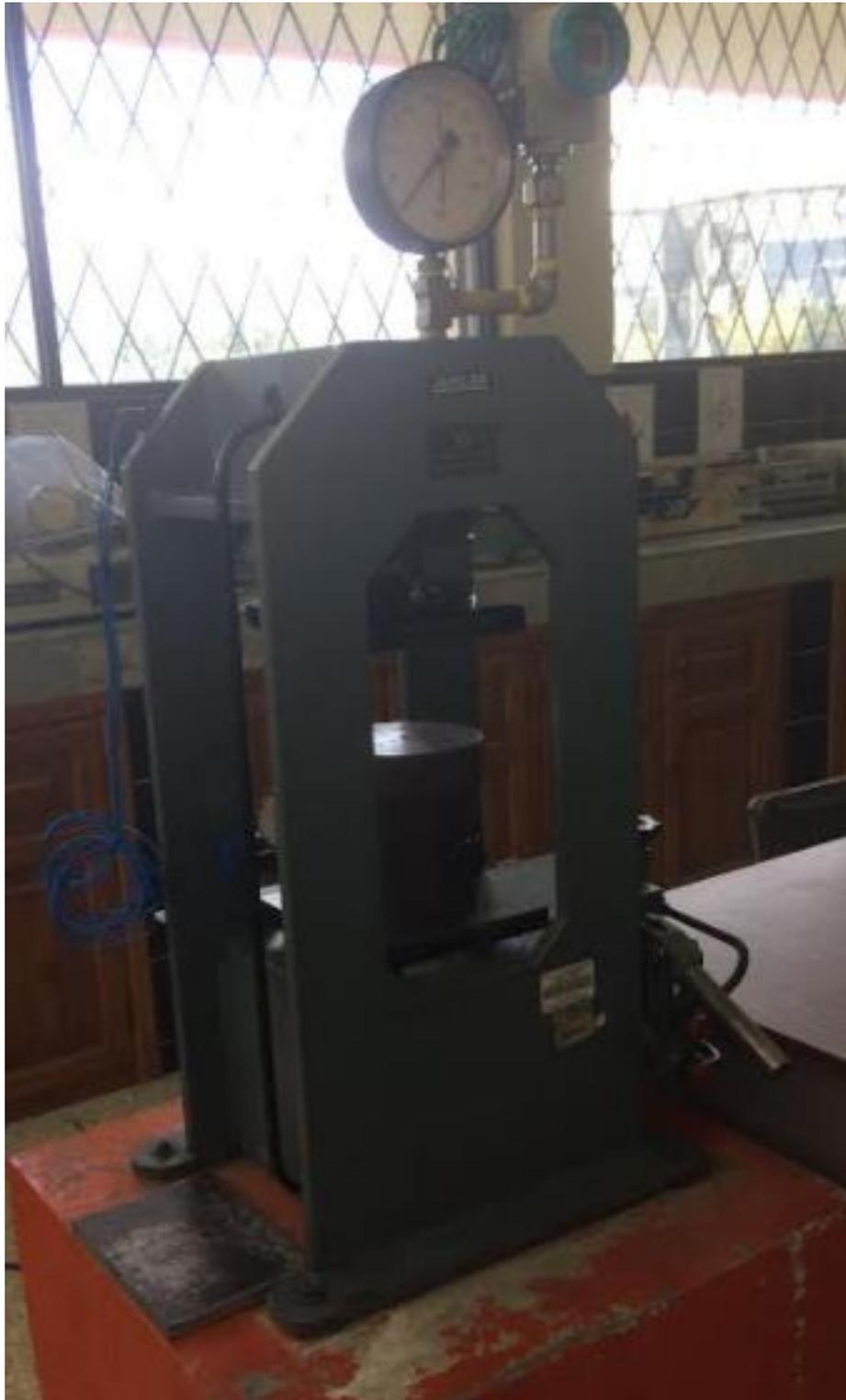
**Figura 24.** Prensa AMSLER de 100 Ton del LRM
