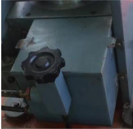
*Figura 39.* Reservorio o depósito de fluido de transmisión hidráulica
