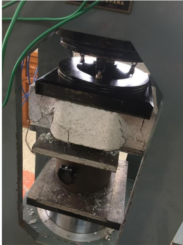
*Figura 153.* Adoquín cargado, se triza o rompe en las zonas fuera de las mordazas o platos de sujeción.
