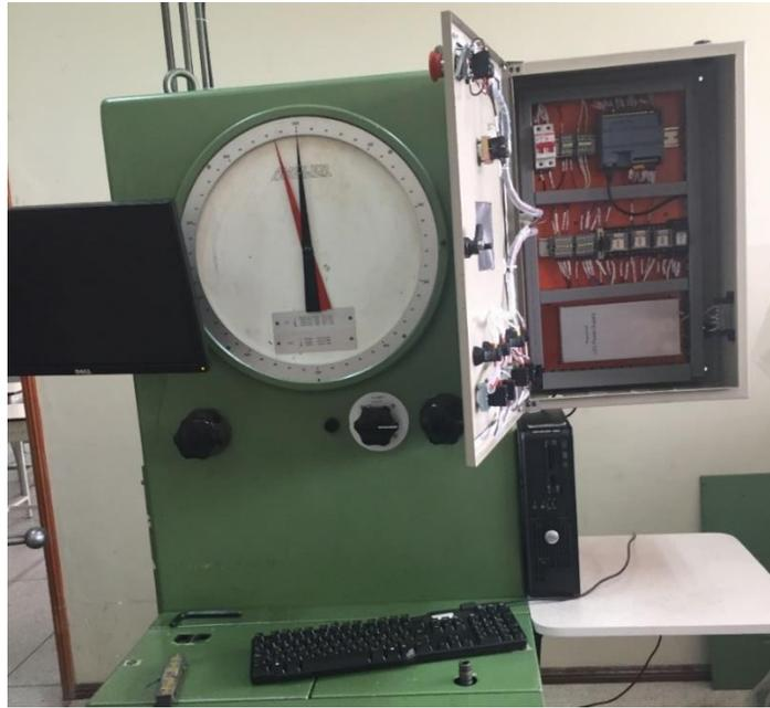
*Figura 47.* PLC visto por dentro
