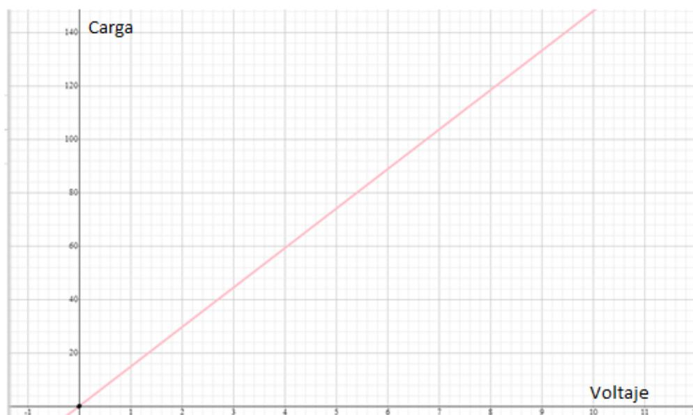
**Figura 51.** Ecuación de calibración del Transmisor de Presión
