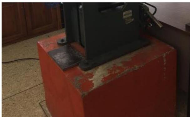
**Figura 36.** Fundación y prensa sobre la fundación en el laboratorio
