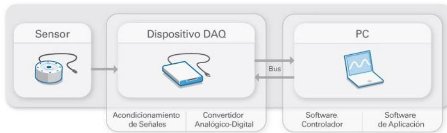
**Figura 19.** Partes de un sistema DAQ
