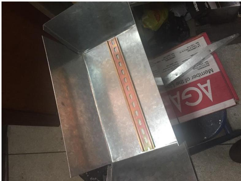
**Figura 144.** Caja casi cerrada por completo, con sección del riel DIN cortada con las dimensiones adecuadas para que quepa dentro de la caja.
