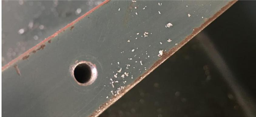
*Figura 91.* Agujero taladrado en el bastidor de la prensa
