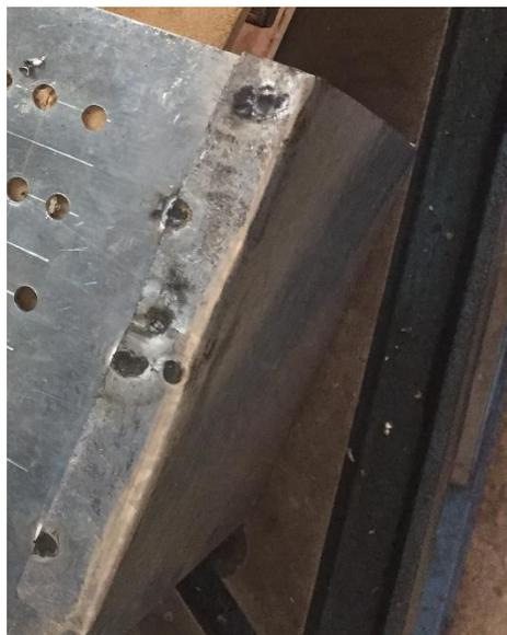
**Figura 145.** Puntos de suelda uniendo una cara de la caja con una pestaña.
