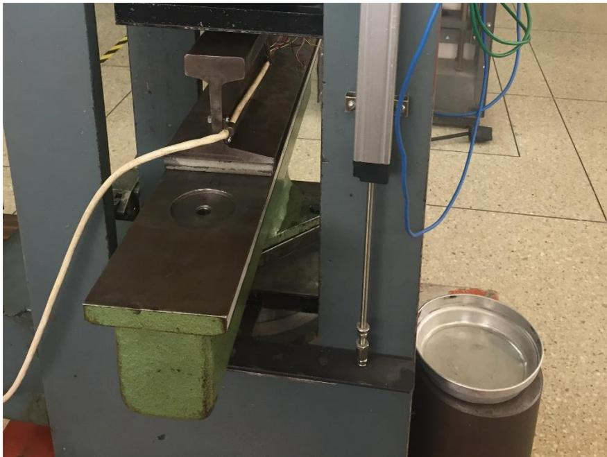
*Figura 93.* Potenciómetro Lineal montado sobre la prensa
