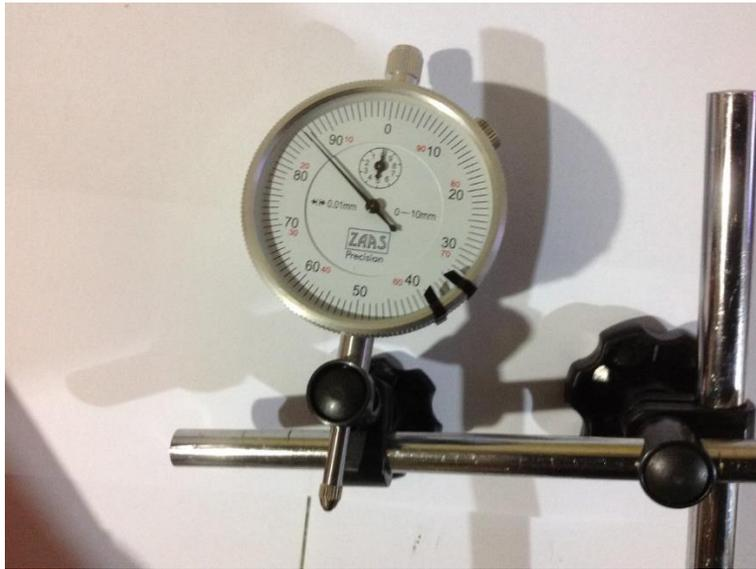
**Figura 33.** Comparador de Reloj para medir desplazamientos
