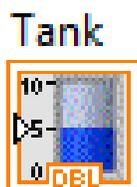
*Figura 78.* Tank en el Diagrama de Bloques de Labview
