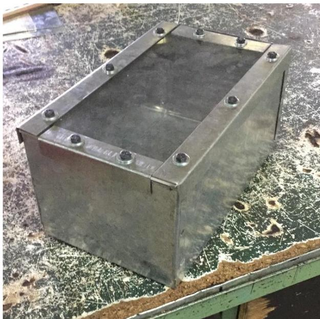
**Figura 147.** Caja porta instrumentos con la tapa de policarbonato transparente.
