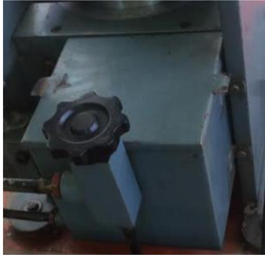
**Figura 29.** Válvula para retorno de fluido de transmisión al reservorio
