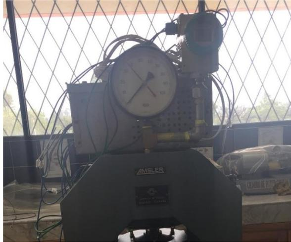
**Figura 150.** Caja porta instrumentos ubicada en la parte superior, posterior de la prensa.
