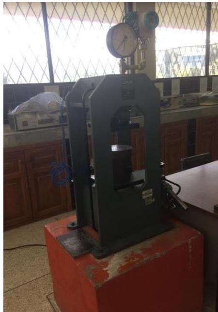
**Figura 34.** Chasis o Bastidor de la Prensa AMSLER
