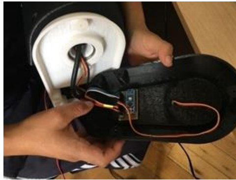
Figura 66. Instalación de la placa electrónica para la iluminación RGB
