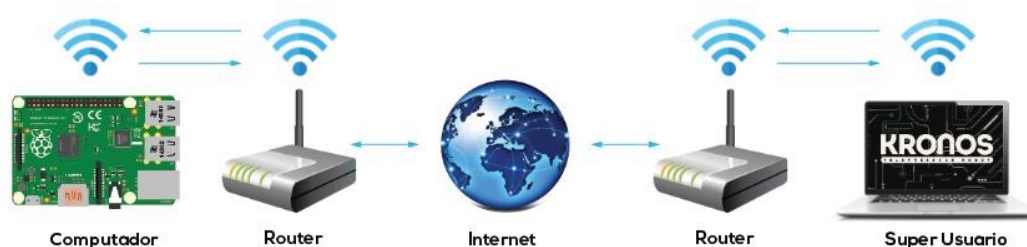
Figura 47. Topología de red del robot de telepresencia
