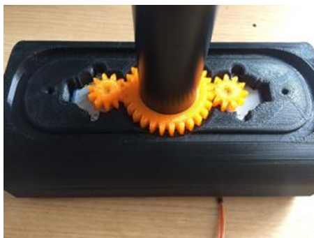
Figura 58. Instalación de los motores a paso y engranajes
