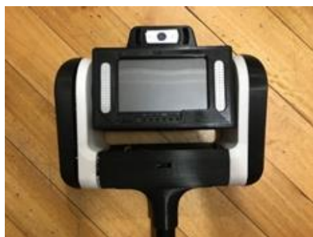
Figura 61. Instalación de la pantalla y la cámara web
