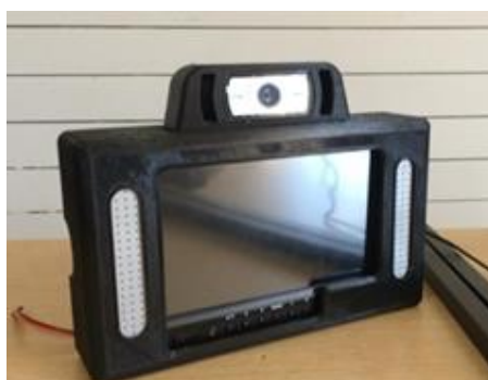
Figura 60. Instalación de la cámara web y la pantalla
