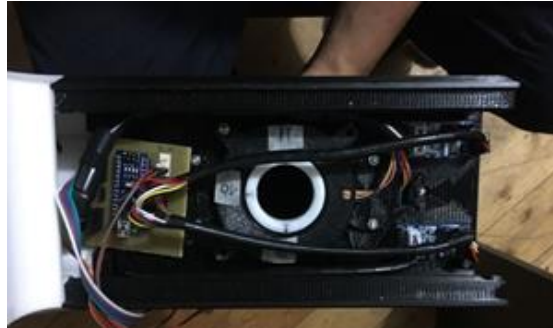
Figura 65. Instalación de placas electrónicas
