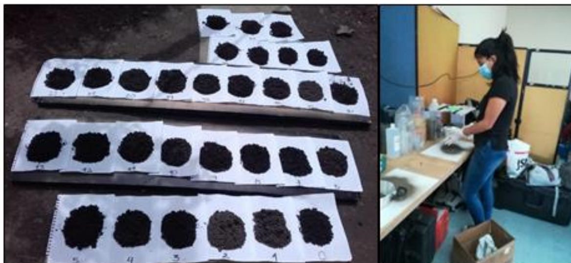
Figura 14. Tratamiento previo de las muestras de suelo
