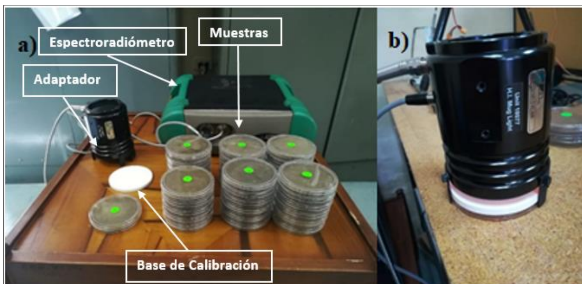
Figura 15. Captura de firmas espectrales a) Preparación de muestras; b) Calibración del equipo
