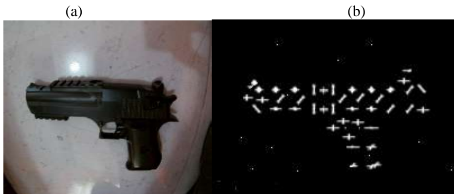
Figura 8. a) imagen de entrada b) imagen con Gradientes de vector HOG Fuente: (Beyeler, 2017)
