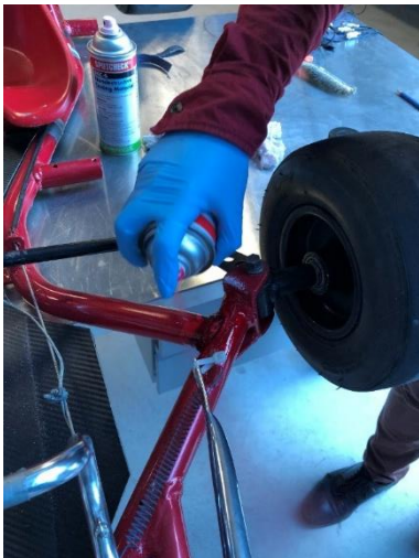
1. Acondicionamiento de la superficie.
