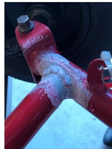
4. Aplicación del revelador.
