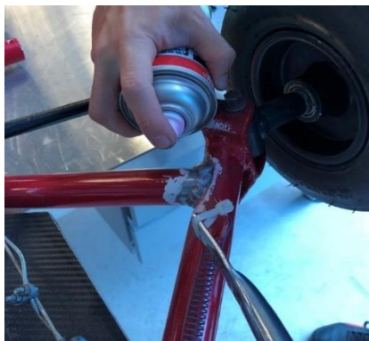
3. Aplicación del penetrante
