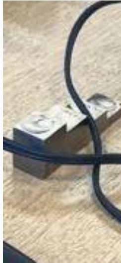
Figura 64. Probeta de calibración del transductor Fuente: (OLYMPUS, 2010)
