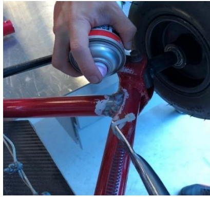
Figura 80. Aplicación del penetrante.
