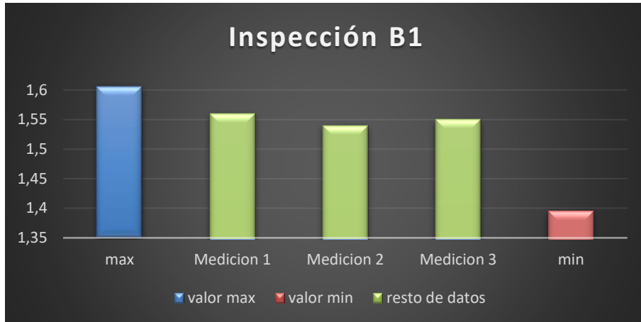
Figura 75. Promedio de espesor en el punto B1 (1.55).
