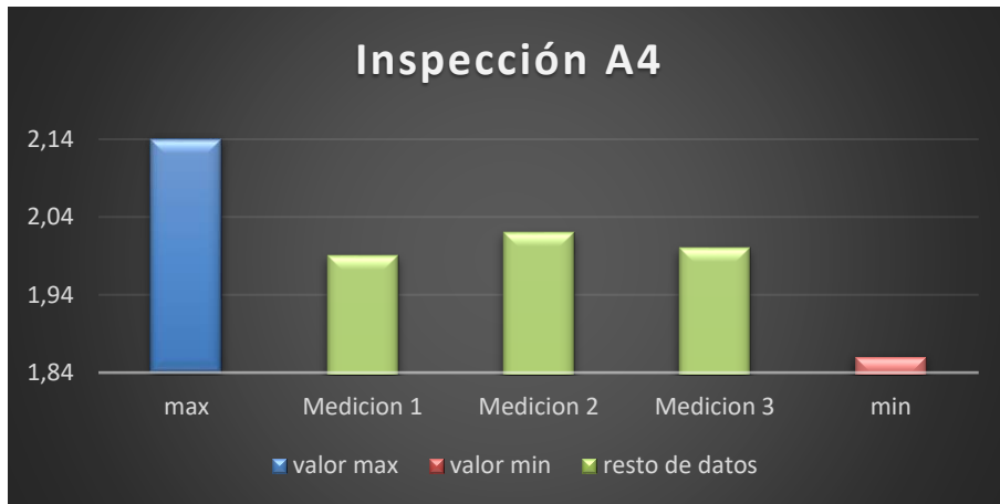
Figura 73. Promedio de espesor en el punto A4 (2.01).
