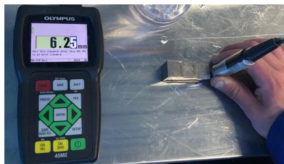
Figura 66. Calibración de menor medida en el rango de la probeta. Fuente: (Centro de Fomento Productivo Metalmeccánico Carrocero, 2018)
