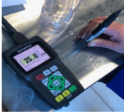
Figura 67. Calibración de mayor medida en el rango de la probeta. Fuente: (Centro de Fomento Productivo Metalmeccánico Carrocero, 2018)
