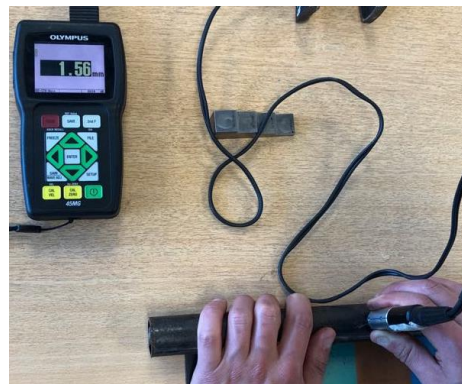
Figura 63. Calibración del medidor de espesores Fuente: (Centro de Fomento Productivo Metalmecánico Carrocero, 2018)
