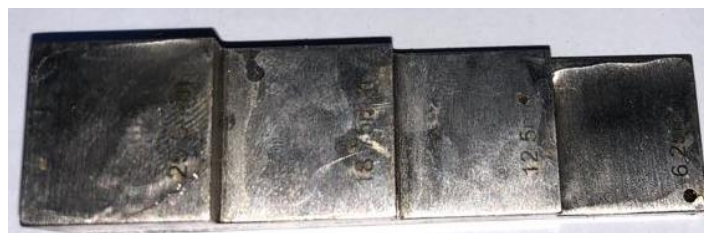
Figura 65. Escala de la probeta de calibración de 6.25mm a 25mm Fuente: (OLYMPUS, 2010)
