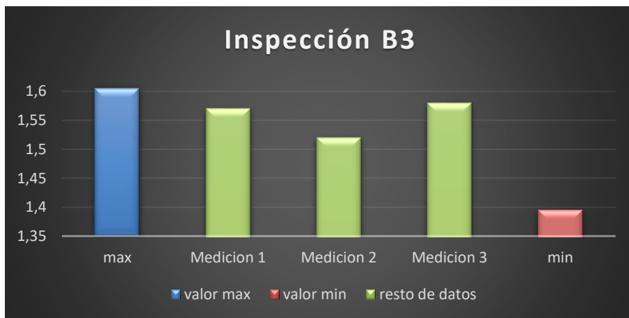
Figura 77. Promedio de espesor en el punto B3 (1.56).
