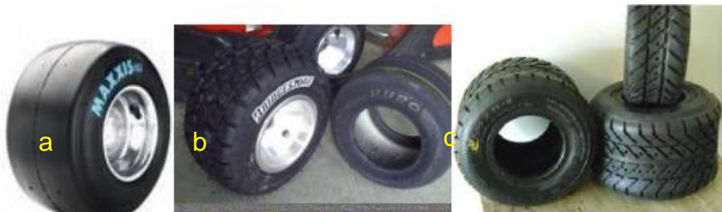
Figura 13. a) Neumáticos asfalto seco, b) húmedo y c) nieve. Fuente: (Alberto, 2012, pág. 41)
