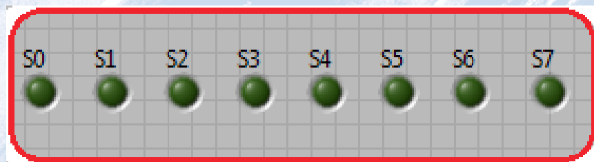
Figura 3.52. Interfaz de salida en LabVIEW para monitorear el estado de las entradas.
