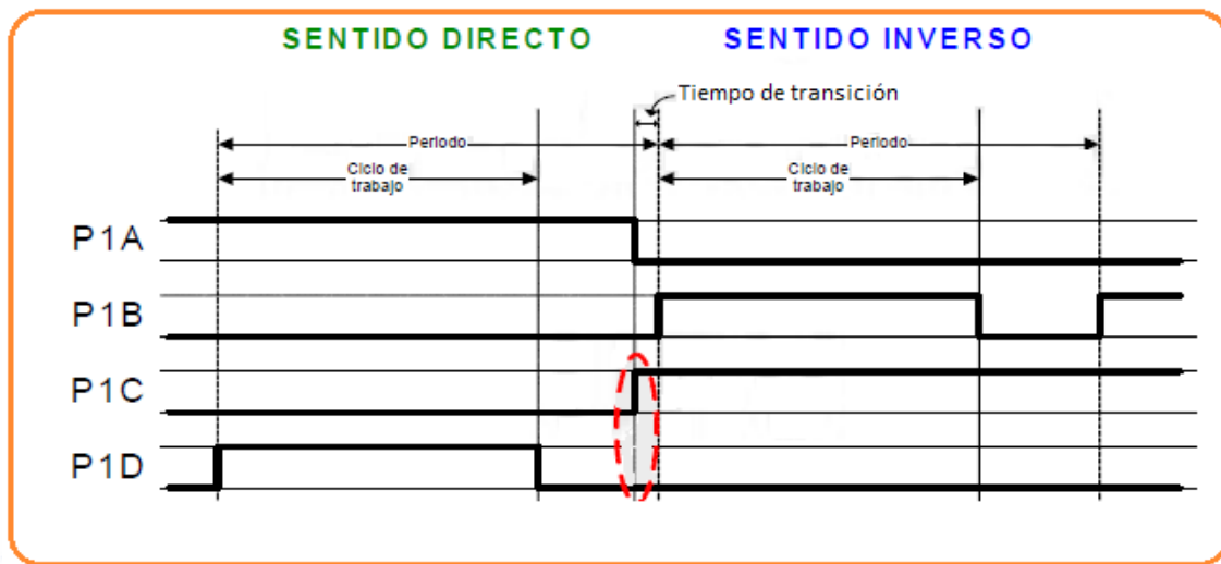
Figura 2.29. Tiempo de transición en modo FULL-BRIDGE. Fuente: PIC18F2455/2550/4455/4550 Data Sheet. Microchip Technology INC.
