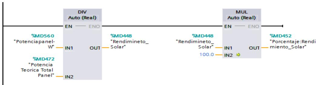
**Figura 52.** Cálculo del rendimiento del generador Fotovoltaico
