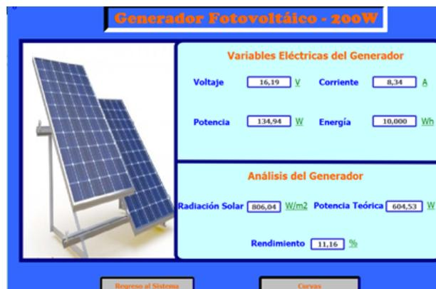
**Figura 69.** Medición de Corriente en los Paneles Fotovoltaicos
