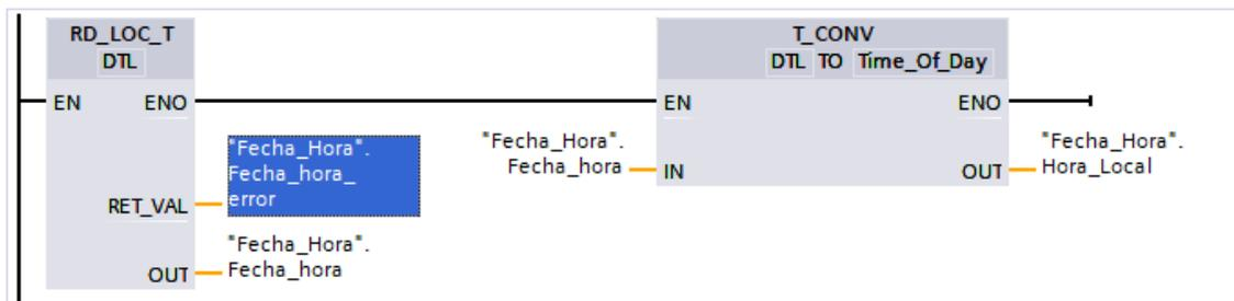
**Figura 53.** Bloques de programación para determinar el tiempo
