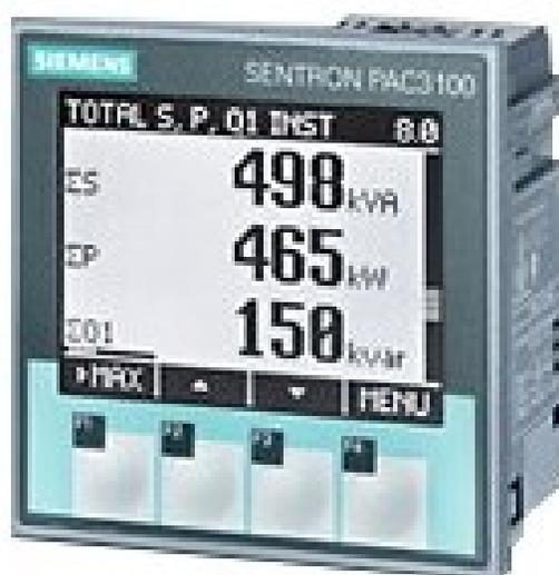
**Figura 23.** Medidor de Energía SENTRON PAC-3100
