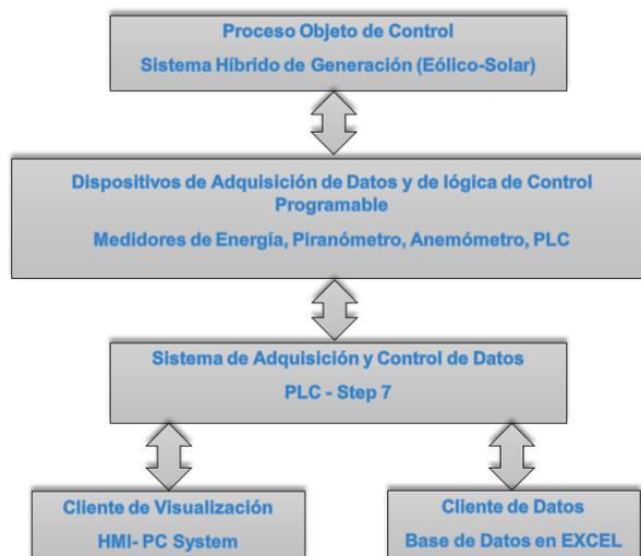
**Figura 27.** Flujo grama del sistema Scada
