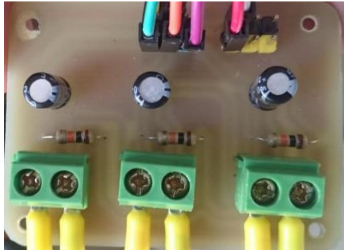
Figura 71. Placa circuito de filtrado
