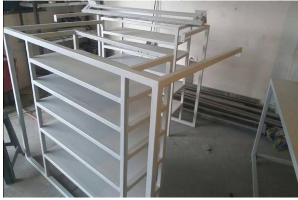
Figura 60. Pintado de la estructura
