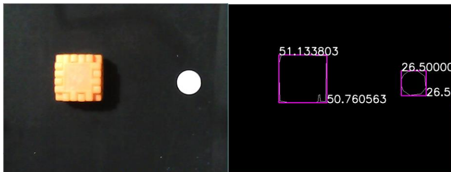
Figura 91. Resultado del proceso de visión artificial
