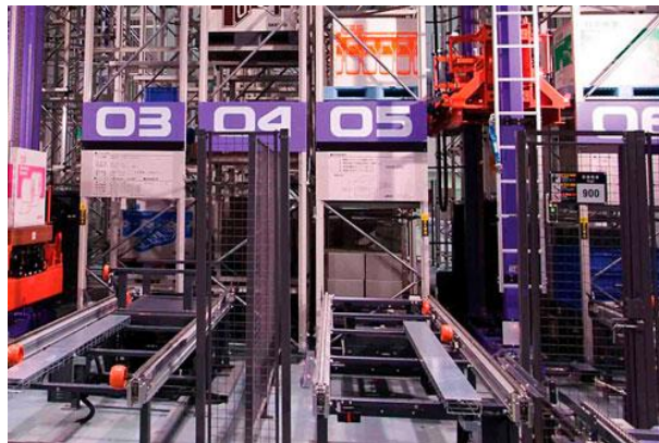
Figura 10. AS/RS de tipo transelevador G.I.EICOM
