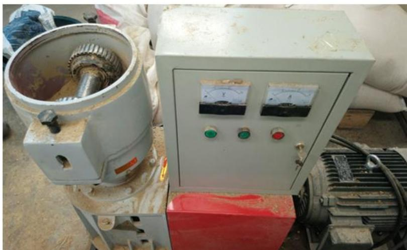
*Figura 10.* Proceso de peletización del alimento balanceado
