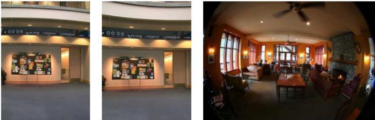
Figura 9. Distorsión radial del lente.
