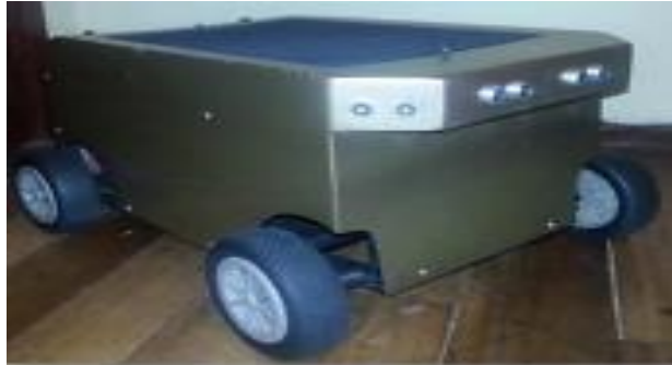
Figura 14. Robot móvil de configuración Ackermann. Fuente: (Moyolema & Pereira, 2014)
