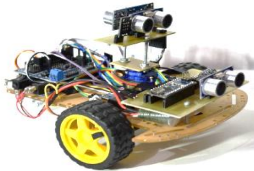
Figura 10. Robot móvil diferencial.
