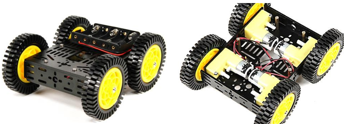
Figura 23. Plataforma robótica móvil DG012-ATV (izq.), vista interna del chasis (der.) Fuente: (Robots, 2018)
