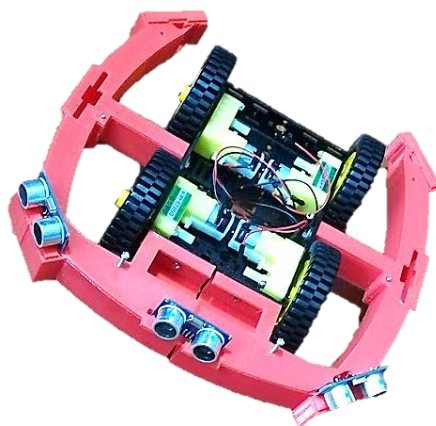
Figura 26. Estructura semicircular para sensores de distancia
