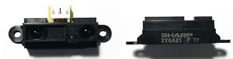
Figura 34. Sensor óptico de distancia SHARP 2Y0A21.
