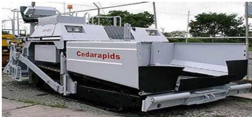
Figura 8. Asfaltadora Cedarapids® utilizada en Ingeniería Civil.
