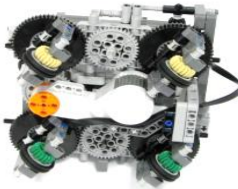
Figura 13. Robot de configuración síncrona. Fuente: (Gómez, 2011)
