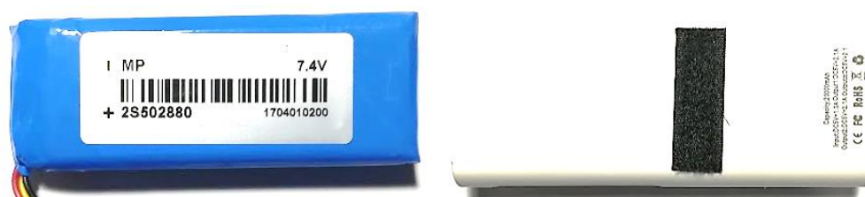
Figura 37. Batería Lipo de 7.4 V (izq.), power bank 20.000 mAh (der.)
