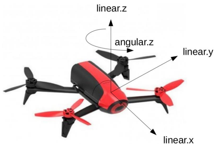
Figura 24 Esquema de desplazamiento de bebop 2 con velocidades positivas Fuente: (Valero, 2017)
