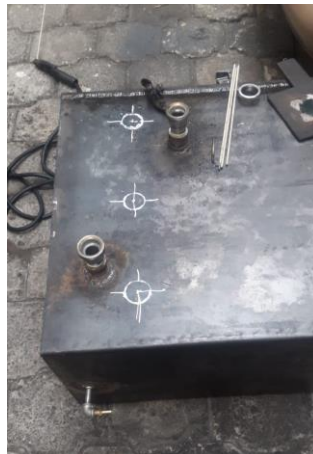
Figura. 26 Construcción de los tanques contenedores de agua
