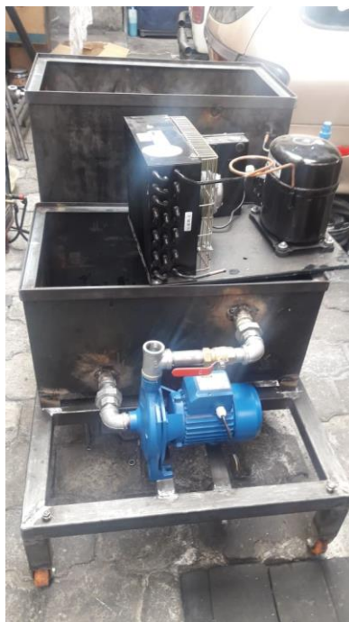
Figura. 29 Montaje del equipo de refrigeración
