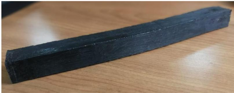
**Figura 63** Fotografía de Probetas 15% Madera - 85% Plástico
