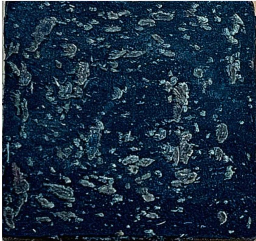
**Figura 134** Fotograf\u00eda de la secci\u00f3n de la probeta 90% Pl\u00e1stico – 10% Madera
