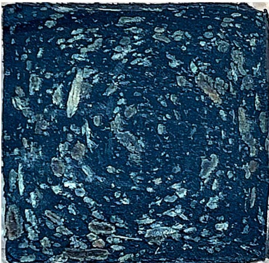
**Figura 135** Fotografía de la sección de la probeta 85% Plástico – 15% Madera
