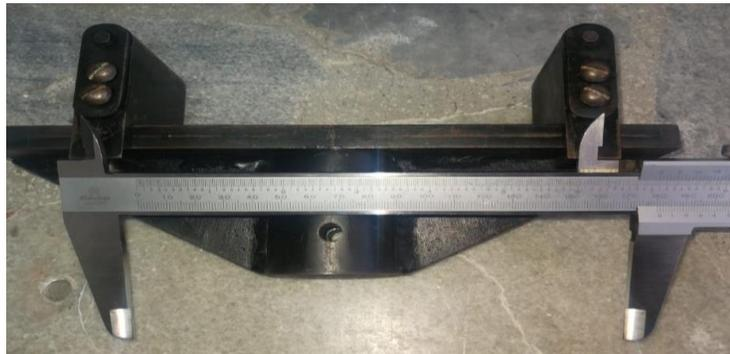
**Figura 69** Acople de la Máquina MTS para ensayos a flexión
