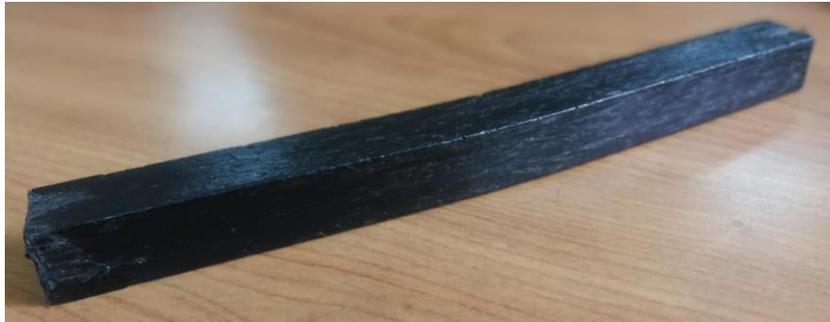
**Figura 62** Fotografía de probetas 10% Madera - 90% Plástico
