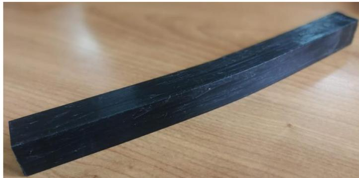
**Figura 61** Fotografía de Probetas 5% Madera - 95% Plástico
