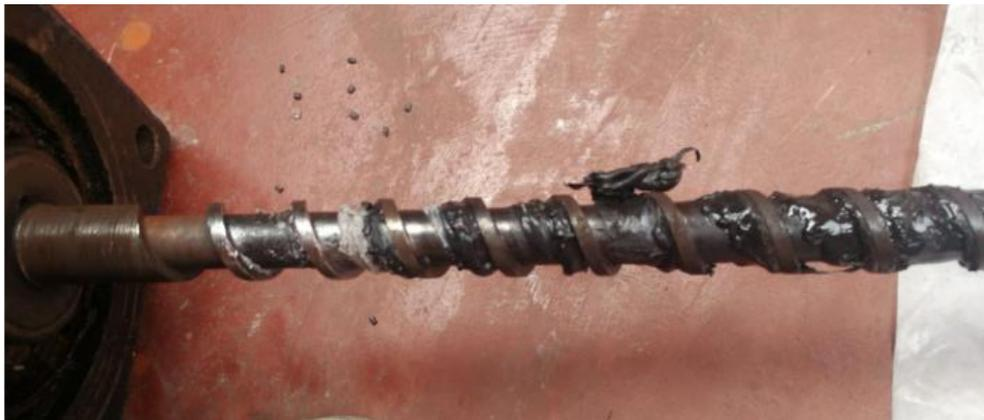
**Figura 12** Limpieza del Tornillo de extrusión
