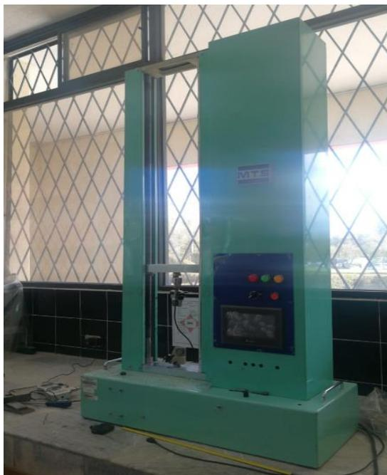
**Figura 65** Máquina de Ensayos Universales MTS
