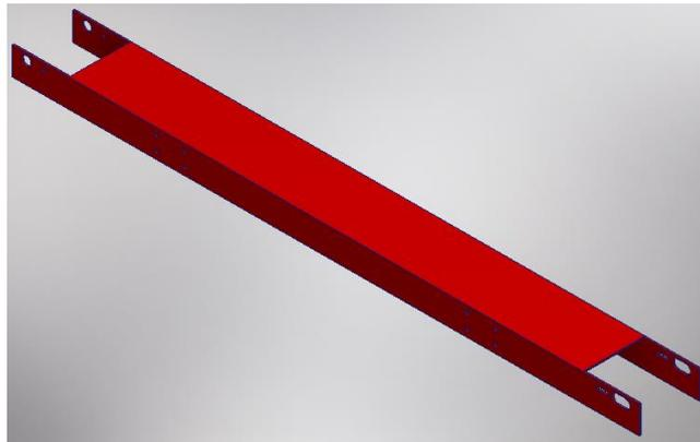
**Figura 13.** Armazón de la banda transportador.
