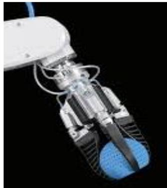
**Figura 6.** Gripper mecánico adaptativo.
