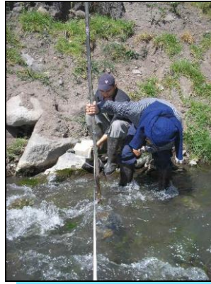
Fotografía 2.2.2.1 Medición del Perfil Transversal del Río
