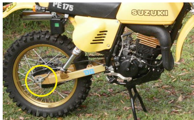
Figura 21. Sistema de ajuste de placa espiral
