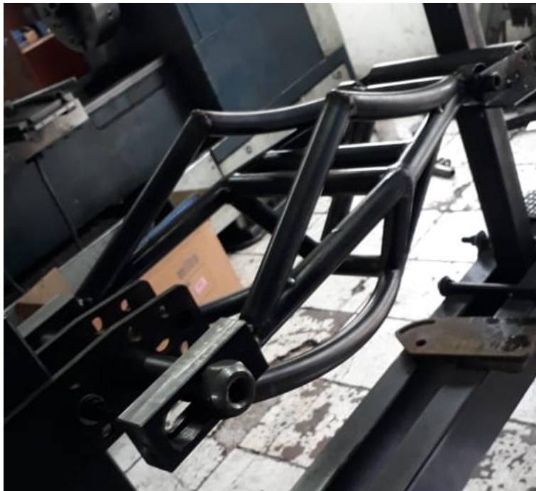
Figura 89. Estructura inferior del basculante
