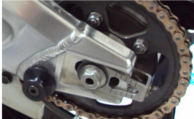
Figura 20. Sistema de ajuste de tornillo y placa
