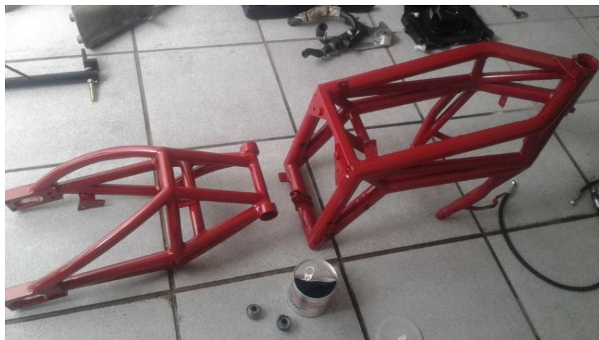
Figura 95. Unión del chasis y basculante
