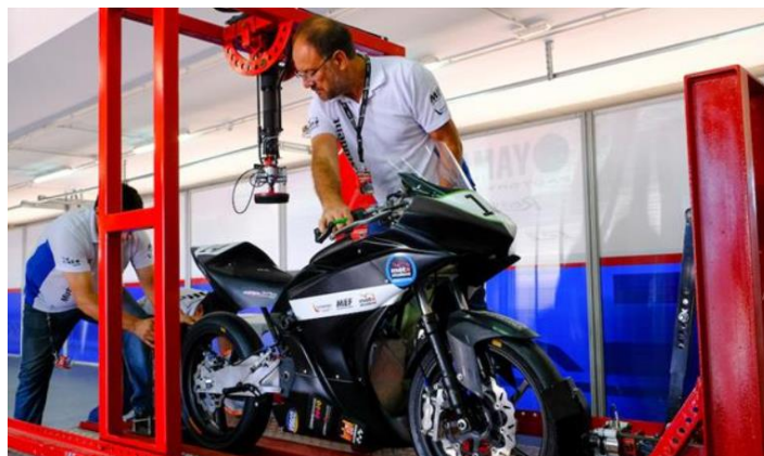
Figura 6. Prueba de verificación estática en la fase MS2
