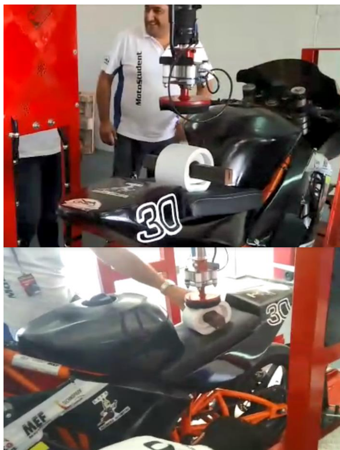
Figura 104. Colocación de la motocicleta en el banco de ensayo
