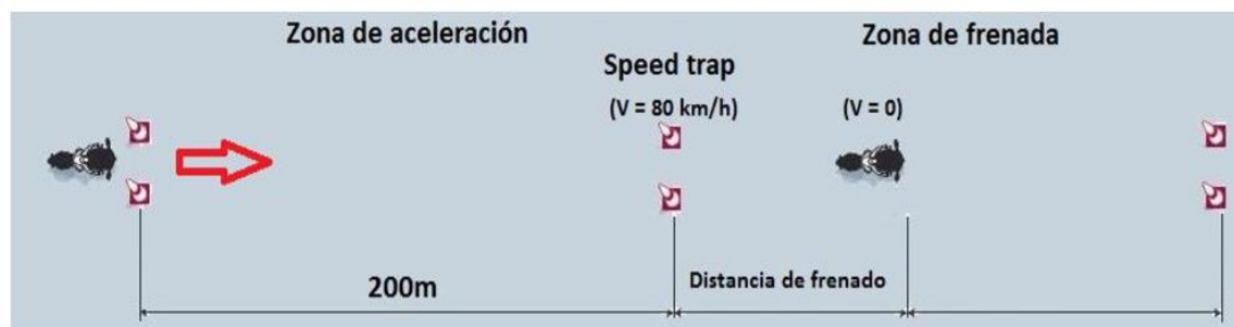
Figura 107. Descripción gráfica de la prueba de frenado Fuente:(MotoStudent, 2017)
