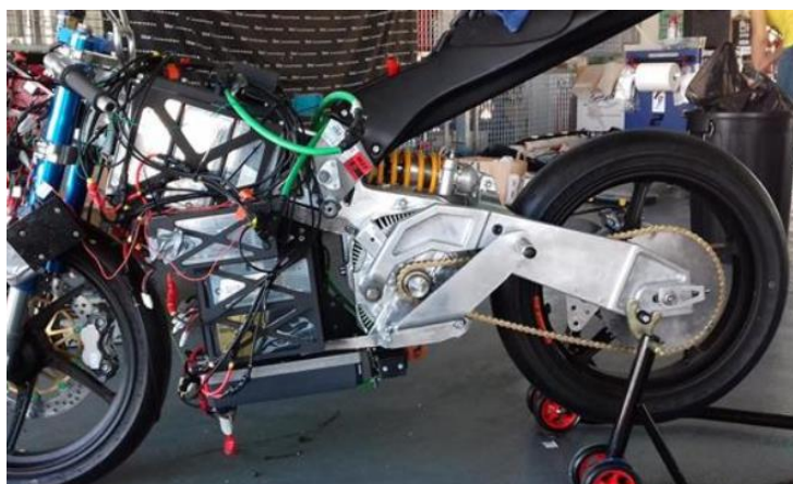
Figura 8. Transmisión por cadena de un prototipo ‘Electric’
