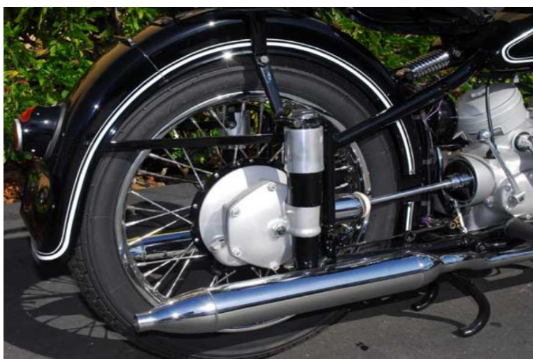
Figura 18. Basculante conexión directa con sistema doublecross
