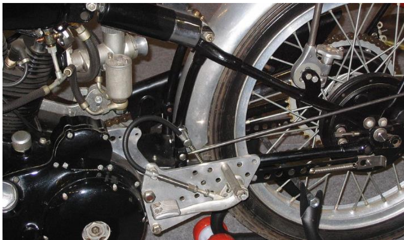
Figura 19. Conexión sistema Cantilever al basculante
