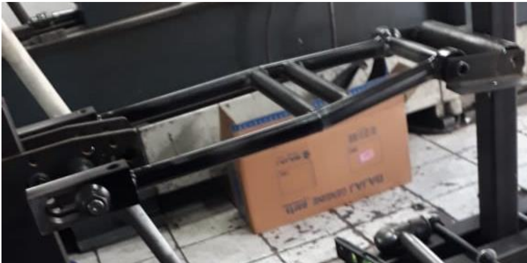
Figura 87. Estructura central del basculante
