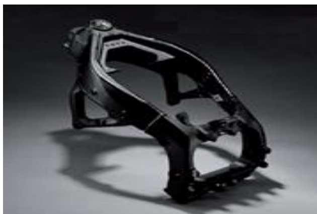
Figura 20. Chasis doble viga Yamaha R6 Fuente: (Casajús, 2012)
