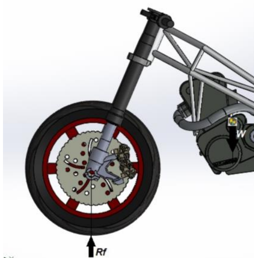
Figura 44. Fuerza en el eje delantero
