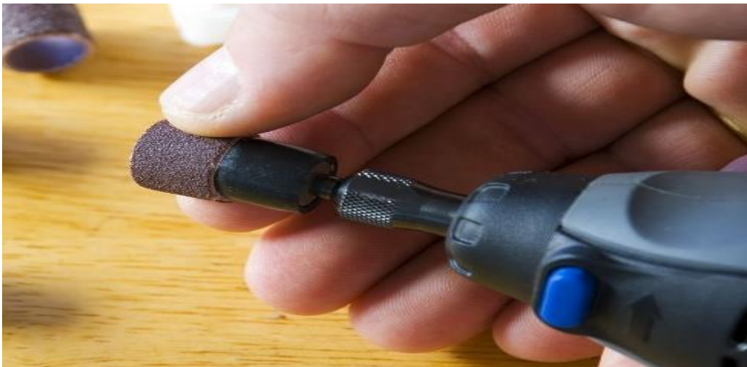
Figura 91. Acoplamiento de lija en máquina dremel
