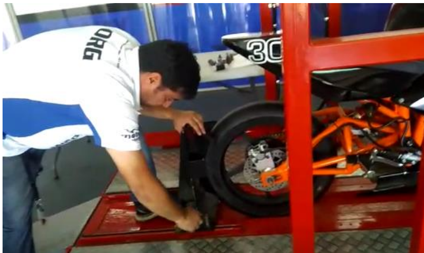
Figura 104. Anclaje de la motocicleta al banco
