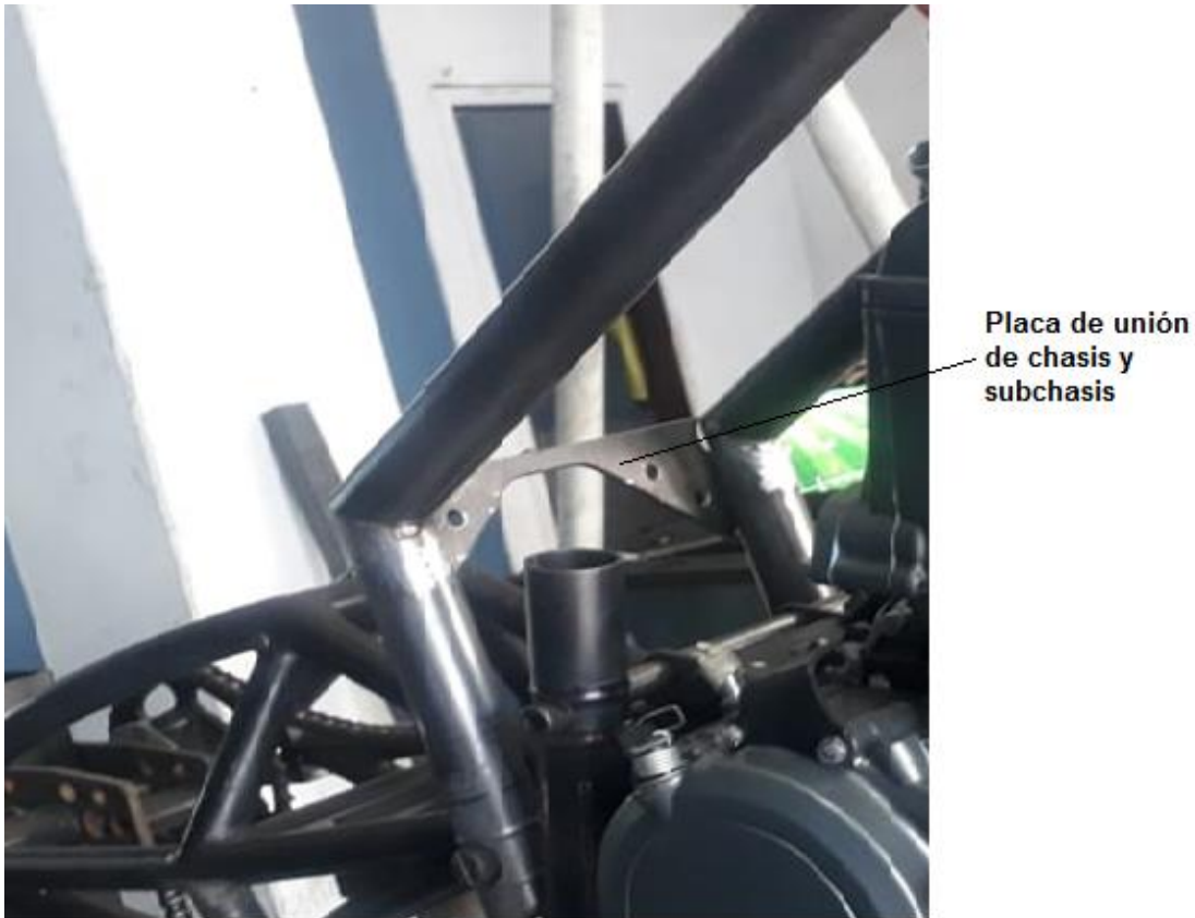
Figura 75. Placas de unión entre el chasis y subchasis
