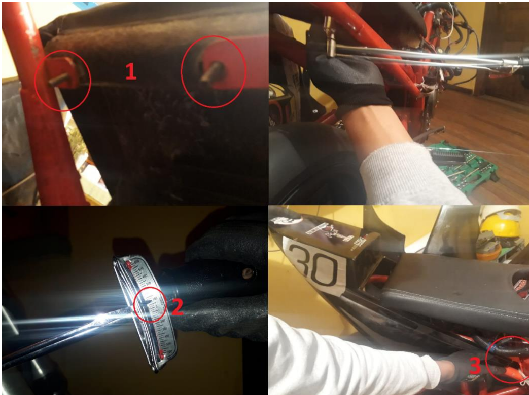
Figura 97. Acople de carenado y asiento
