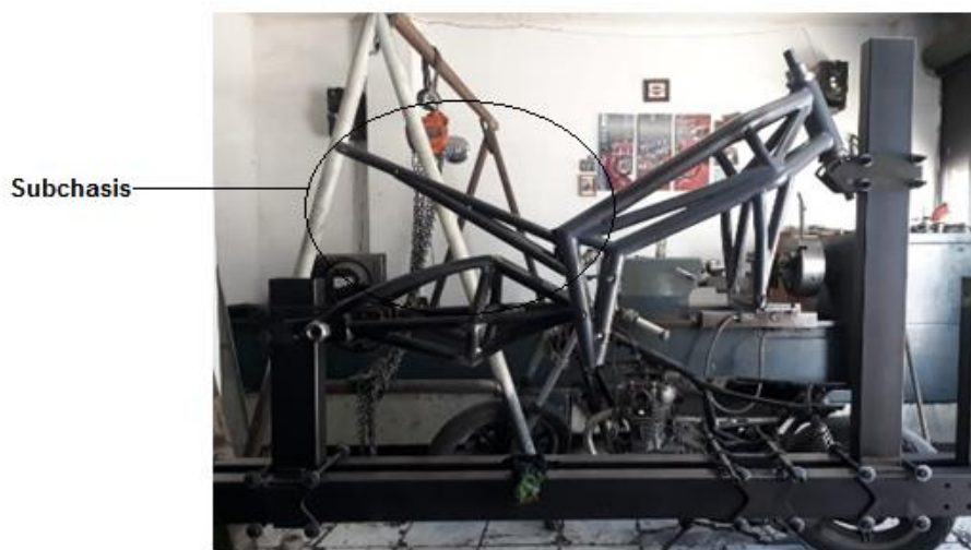
Figura 86. Armado completo del chasis y subchasis
