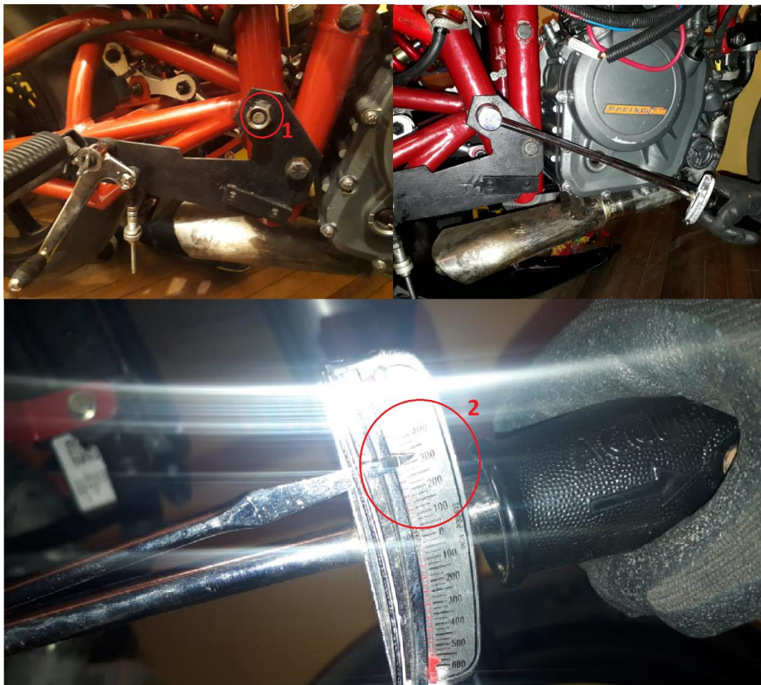
Figura 94. Colocación de basculante
