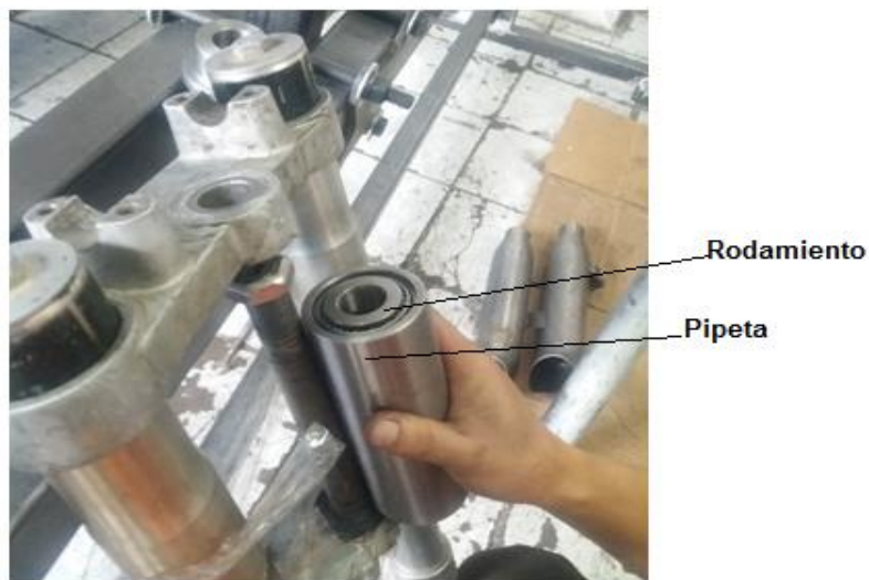
Figura 82. Pipeta terminada con los rodamientos puestos
