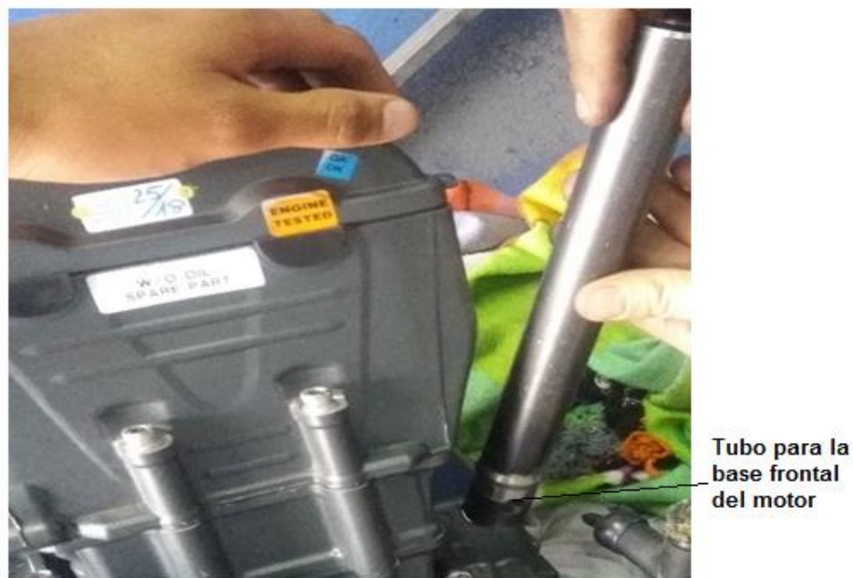
Figura 78. Acople del tubo fresado para base del motor
