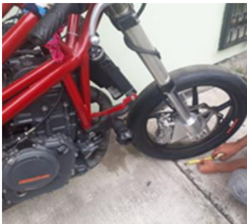
Figura 100. Verificación del avance
