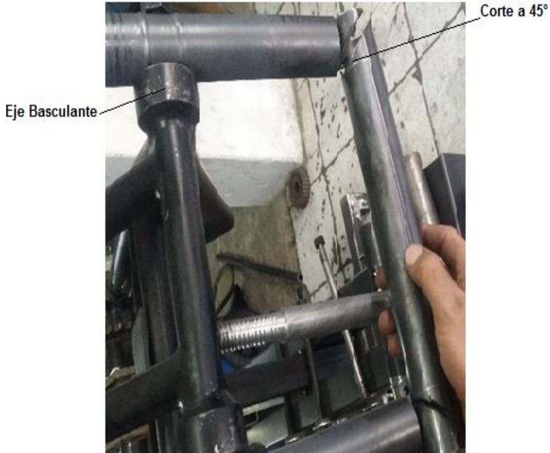
Figura 76. Corte a 45° para fijación de estructura principal
