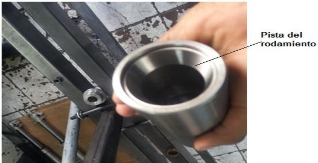
Figura 81. Pipeta para la inserción de rodamientos
