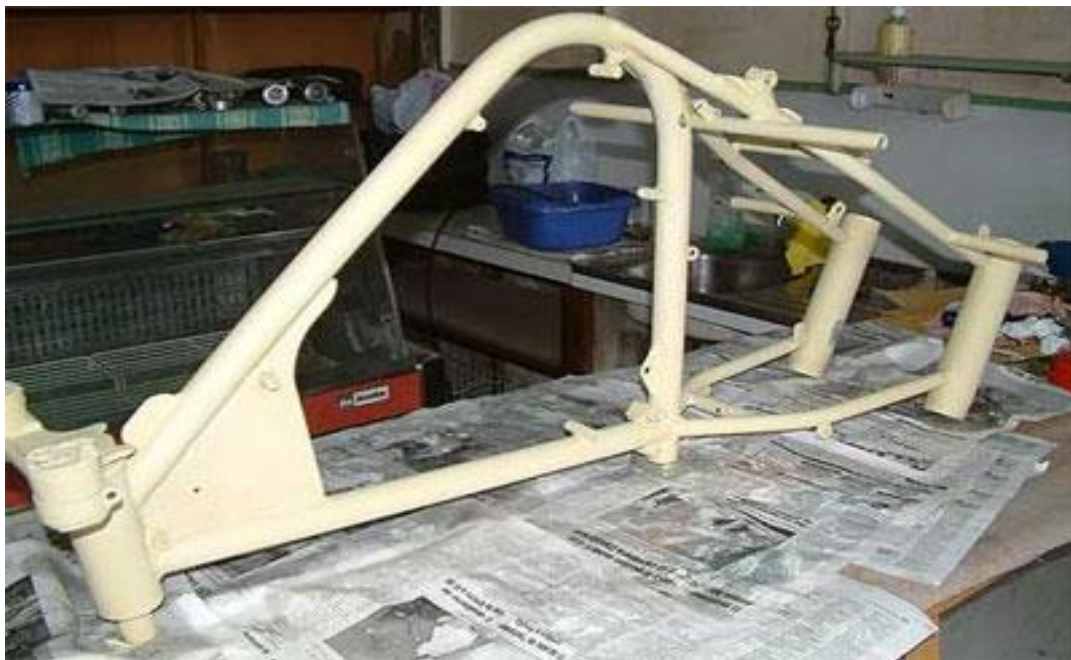
Figura 92. Secado de primera capa de fondo
