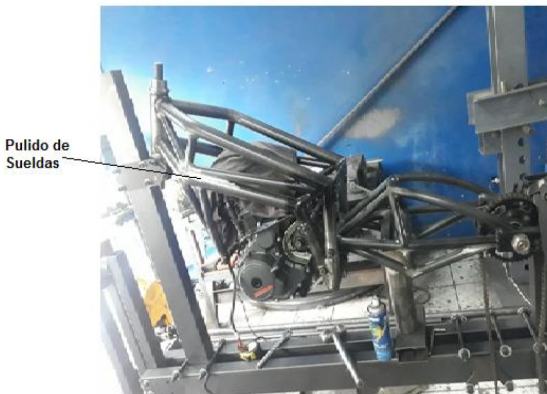
Figura 88. Soldas pulidas del chasis
