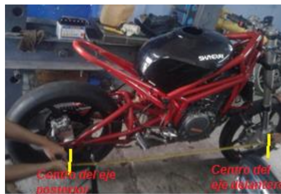
Figura 99. Verificación de la distancia entre ejes
