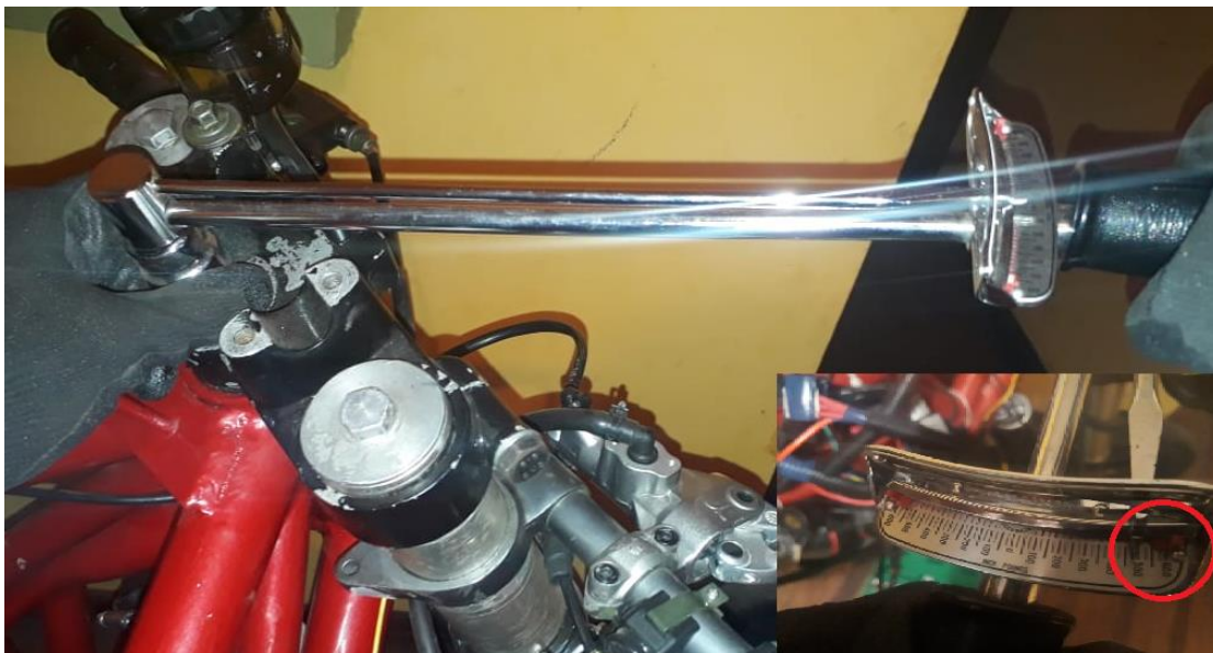
Figura 95. Montaje de horquilla respecto al chasis
