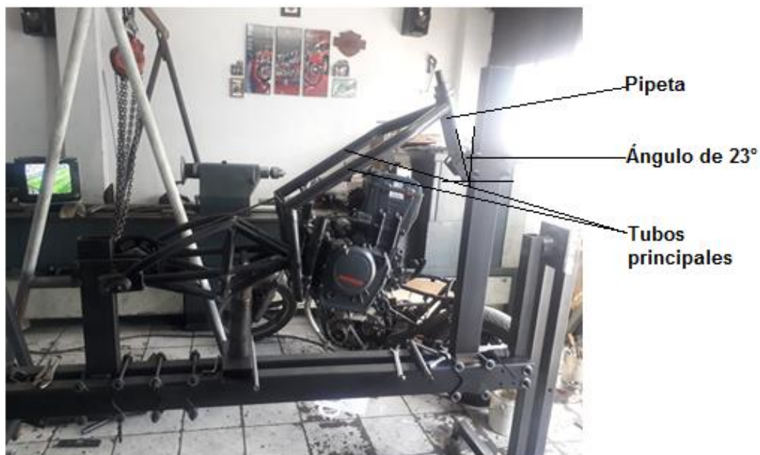
Figura 84. Fijación de tubos principales y montaje del motor
