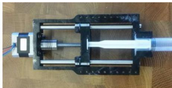
Figura 15. Extrusor tipo tuerca
