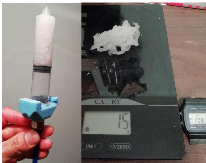
Figura 56. Prueba de fluidez polímero resultante 2
