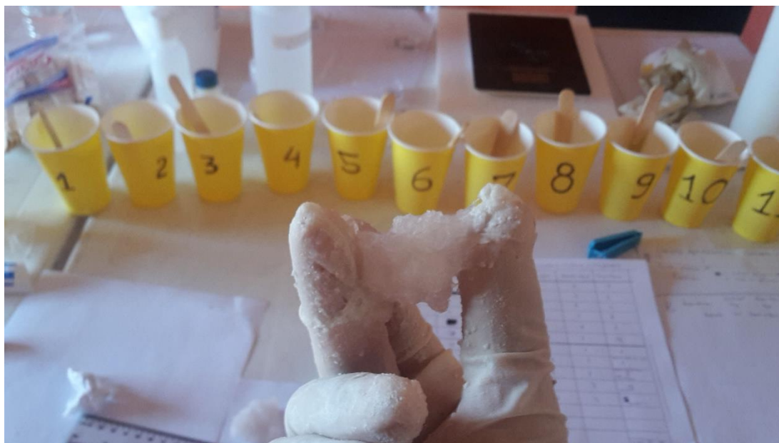
Figura 45. Determinación de la solidez de cada polímero resultante
