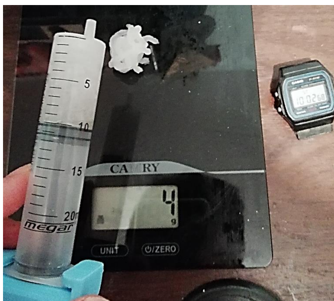
Figura 49. Medición del MFI
