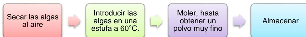
**Figura 6.** Diagrama de proceso para la preparación de la muestra.
