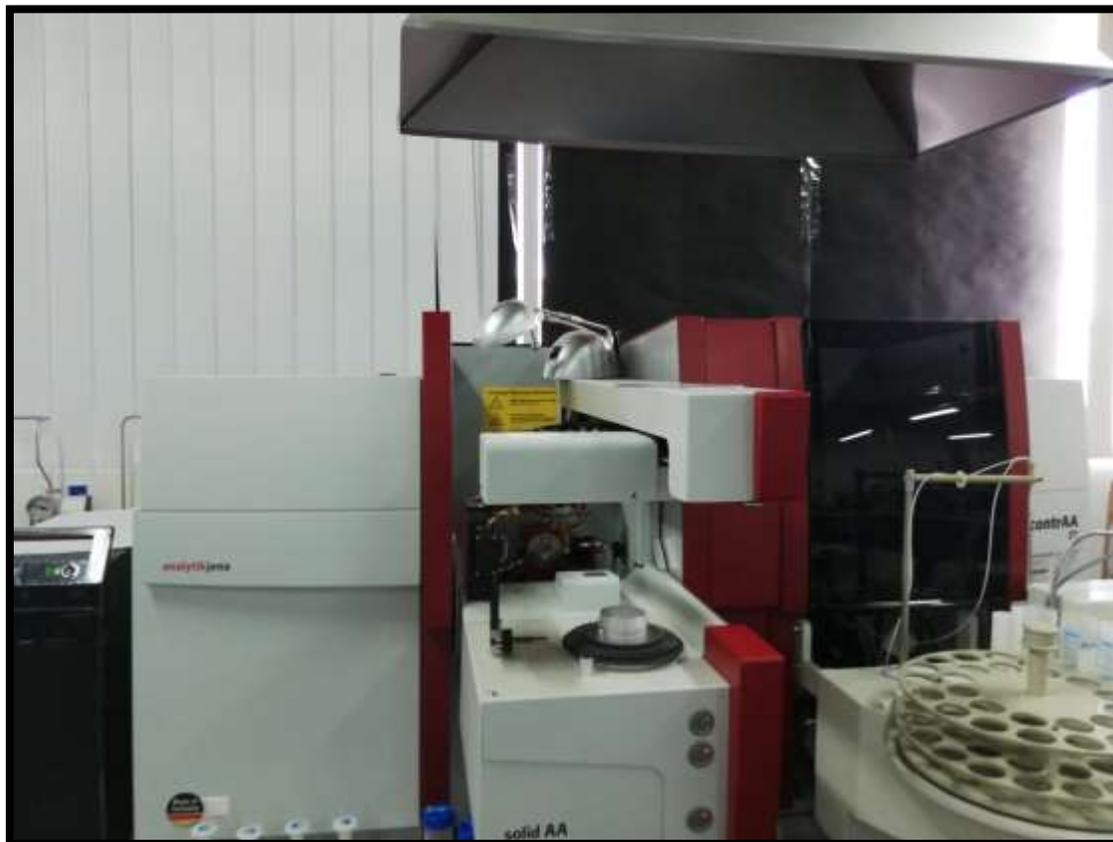
**Figura 3.** Espectrofotómetro de Absorción Atómica ContrAA 700
