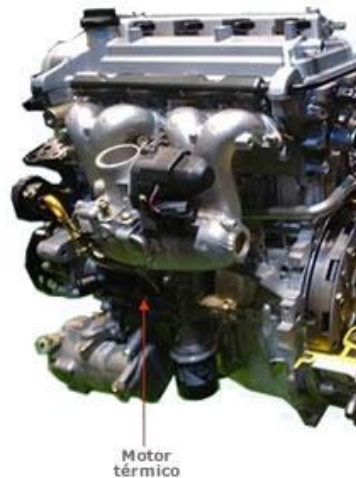
Figura 9. Motor de combustión interna ciclo Atkinson
