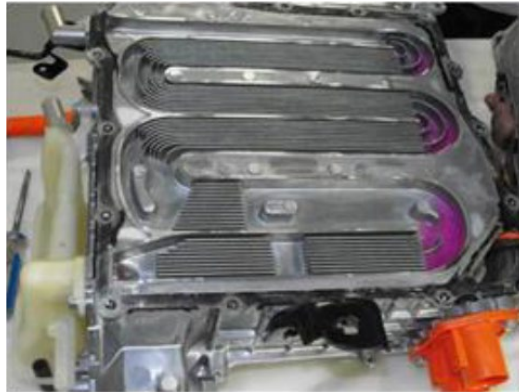
Figura 13. Sistema de refrigeración del inversor
