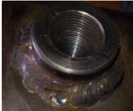
Figura 6. Soldado del eje de transmisión el tubo rectangular.
