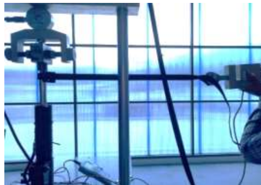
Figura 47. Aplicación de carga lateral a la guía de la barra del cuerpo del puntal.
