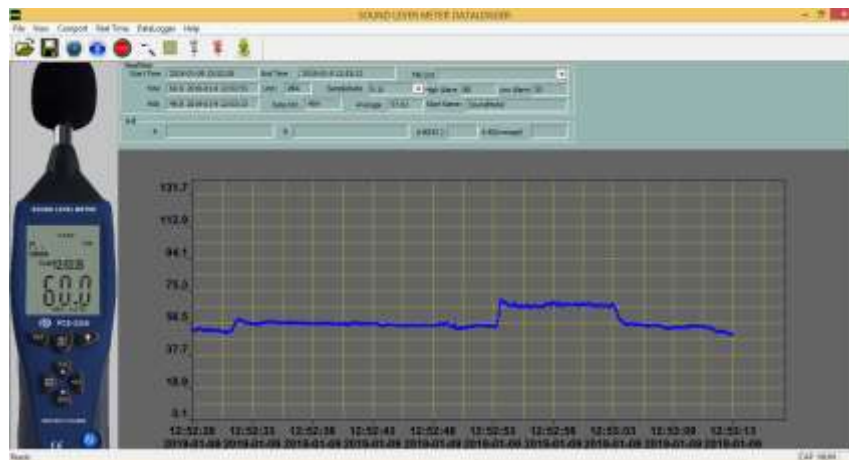
Figura 56. Registro del nivel máximo de presión sonora A. Original. Fuente: Software Sound Level Meter Datalogger.
