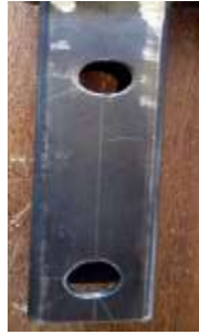
Figura 4. Perforación de los agujeros en el tubo cuadrado.
