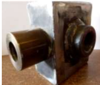
Figura 10. Soldadura del bocín.
