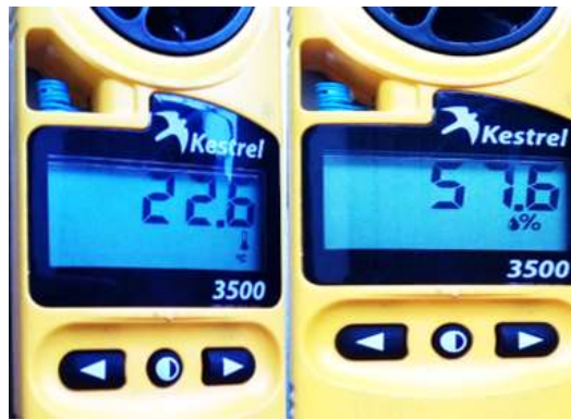
Figura 19. Condiciones ambientales de las Prueba 1-Step Fijo.
