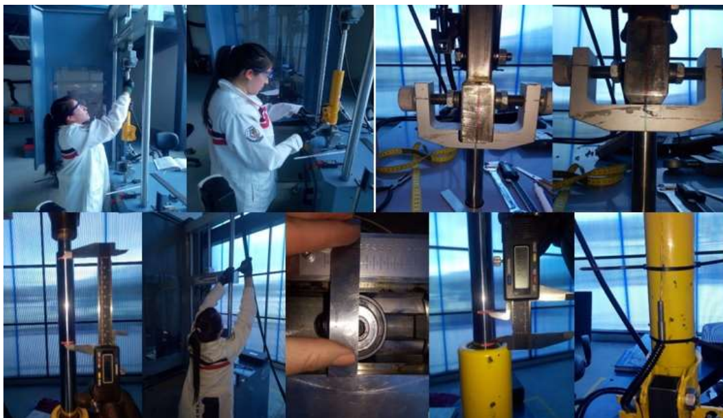
Figura 93. Colocación del amortiguador alterno 2 en el banco de pruebas.
