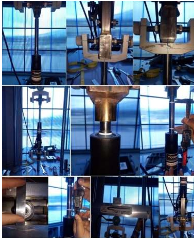
Figura 60. Colocación del amortiguador Alterno 1 en el banco de pruebas.
