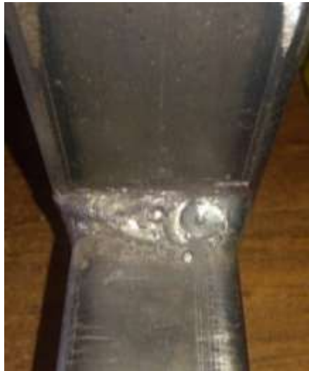
Figura 7. Soldado del tubo rectangular y cuadrado.
