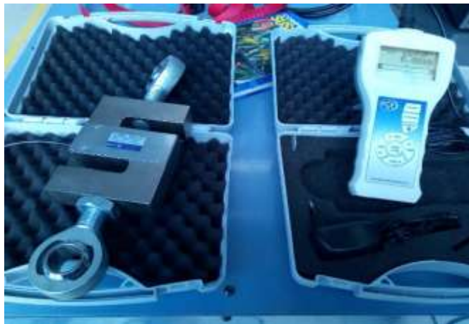
Figura 46. Dinamómetro para aplicación de carga lateral en la prueba de resistencia al deslizamiento.
