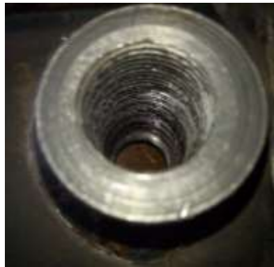
Figura 5. Perforación del eje de transmisión y roscado.
