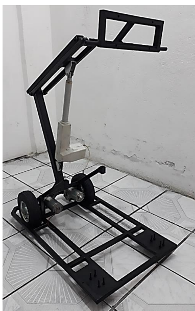
Figura 105. Instalación actuador lineal
