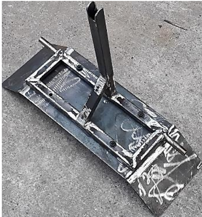
Figura 99. Soldadura estructura pechera
