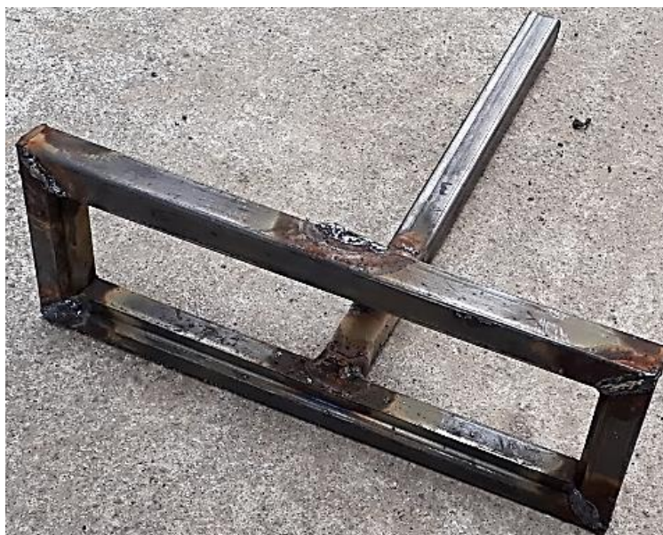
Figura 96. Estructura apoyo pechera
