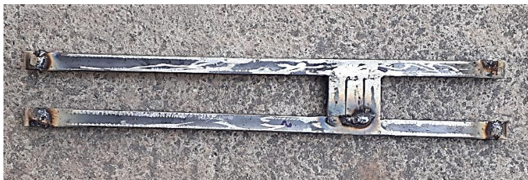
Figura 100. Soldadura perfiles auxiliares
