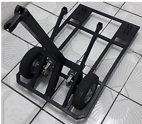
Figura 104. Instalación motores – llantas
