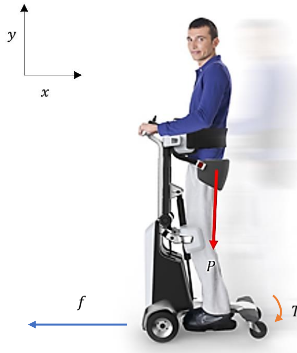
Figura 38. Cargas presentes en el desplazamiento del bipedestador
