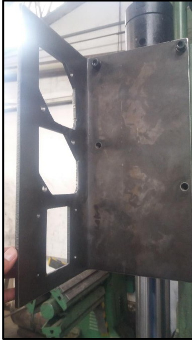
Figura 61. Soporte Dispositivos hidráulicos
