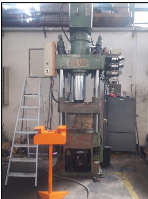
Figura 96. Prueba en vacío del funcionamiento de la prensa.
