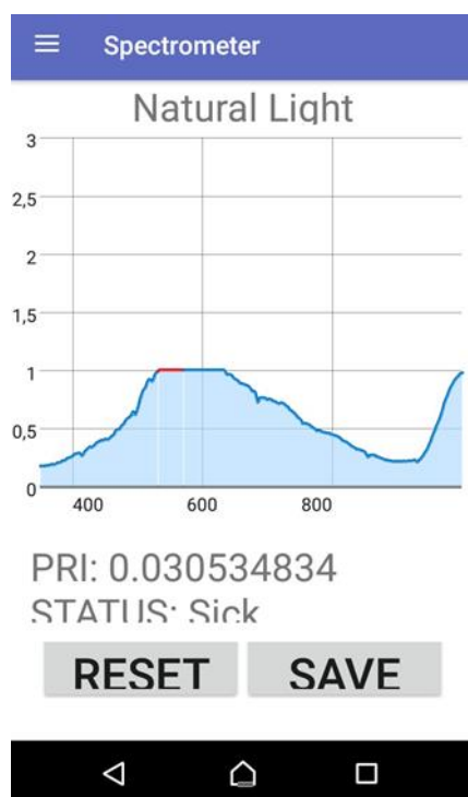
Figura 72 Pantalla para visualizar la reflectancia vs longitud de onda electromagnética.
