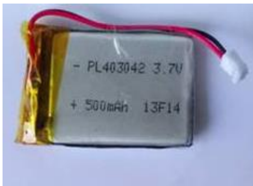
Figura 77 Batería de li- Po 500 mAH a 3.7 v
