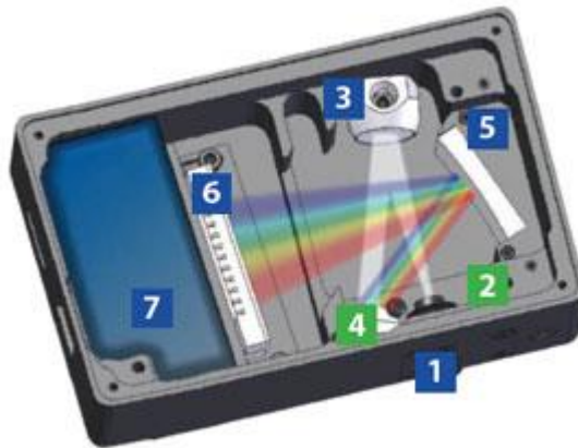
Figura 26 estructura interna del detector
