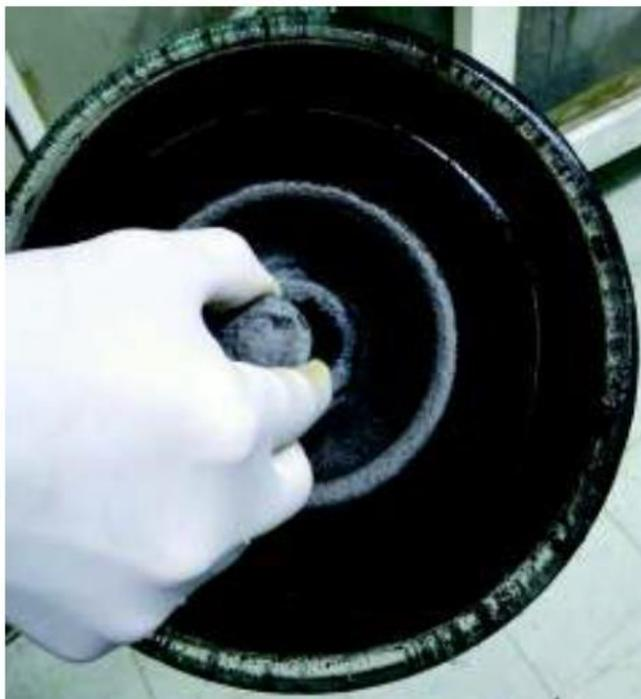
**Figura 16.** Adherencia de ceniza volcánica con humedad
