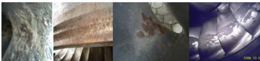
**Figura 6.** Partes de corroídas de la Central San Francisco
