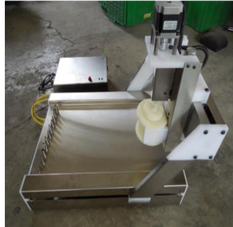
Prototipo de dispositivo cartesiano decorador de pasteles por procesamiento de imagen
