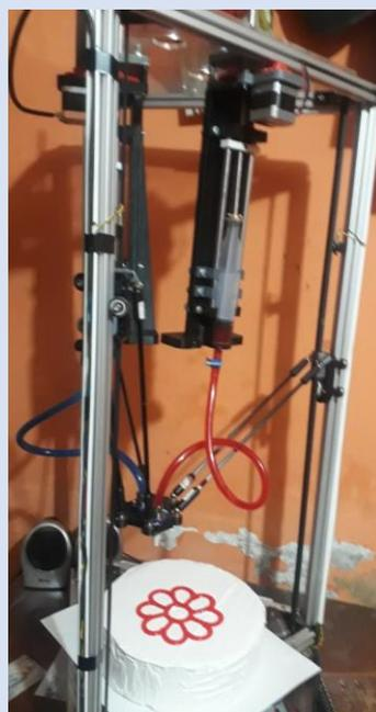
El sistema mecatrónico para el decorado superior de pasteles tiene como fundamento emplear diseños personalizados para realizar el decorado de diversos productos de la repostería como pasteles, galletas, cupcakes, etc. empleando una aplicación desarrollada mediante Python que permite crear un diseño autónomo.
