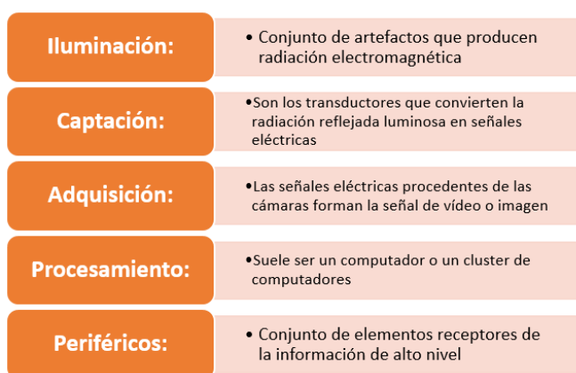
Figura 11. Subsistemas físicos de un subsistema de visión artificial Fuente: (BUSTAMANTE, 2014)
