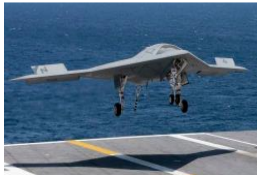
Figura 15. Sistema de aterrizaje con tren de aterrizaje
