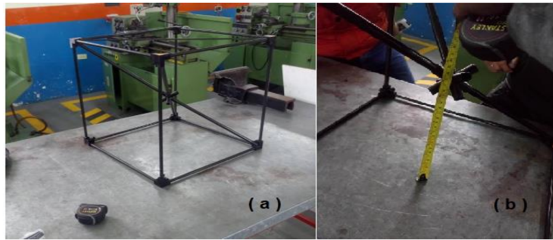
Figura 78. a) Estructura de comprobación b) Verificación de la distancia al centro de masa
