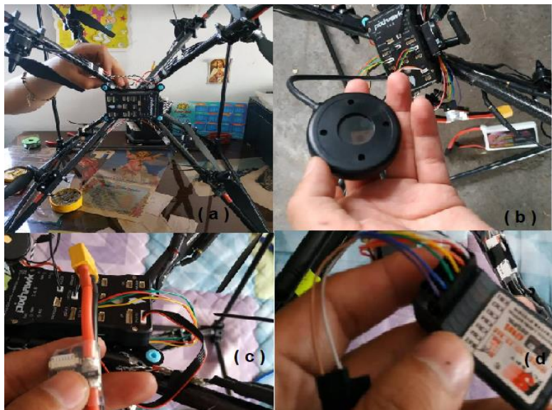
Figura 86. a) Acople de la Tarjeta de control b) Módulo Gps c) Regulador de Tensión d) Módulo RC.
