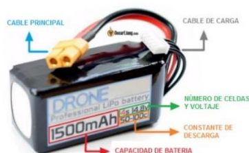
Figura 47. Características de una batería Lipo.
