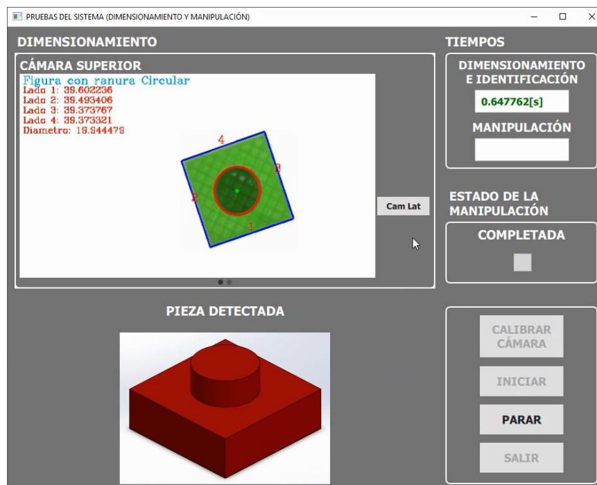
Figura 111. Dimensionamiento e identificación de la pieza base del ensamble A modelo 1 – cámara superior
