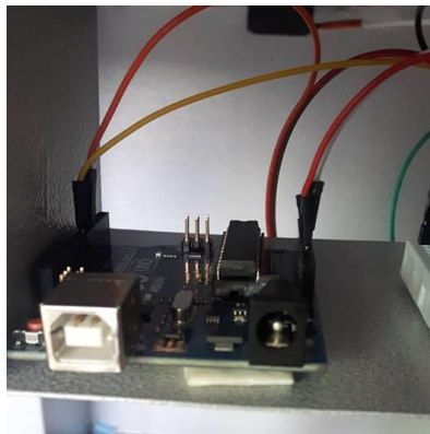
Figura 83. Tarjeta de control implementada a su respectivo soporte
