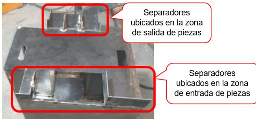
Figura 59. Separadores soldados en la parte superior de la estructura
