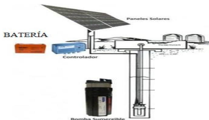
**Figura 7.** Sistema de bombeo solar con batería
