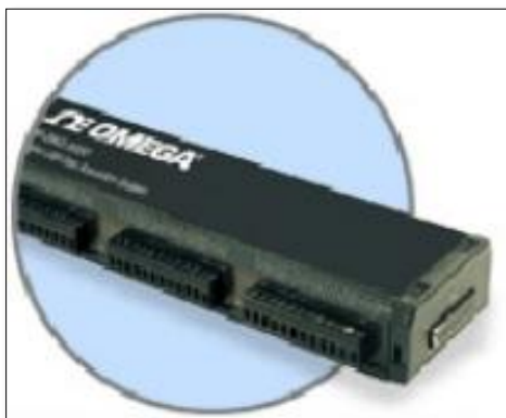
Figura 8 Módulo de adquisición de datos con Puerto USB, OMB-DAQ-3000. Fuente: (academia, 2018)
