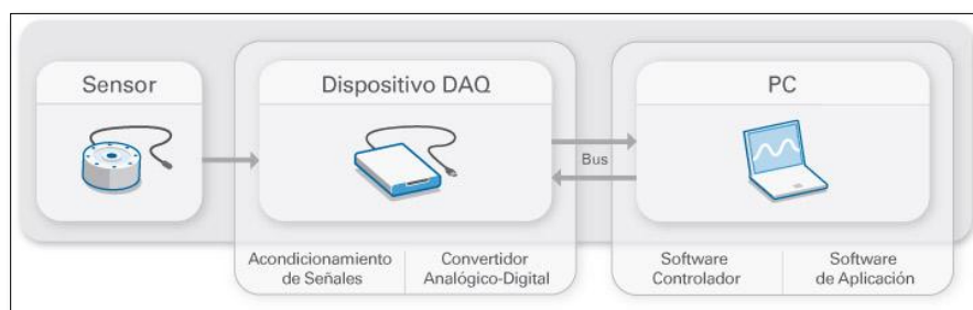
Figura 5 Partes de un sistema DAQ
