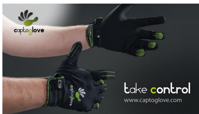
Figura 21. Guante de datos Captoglove
