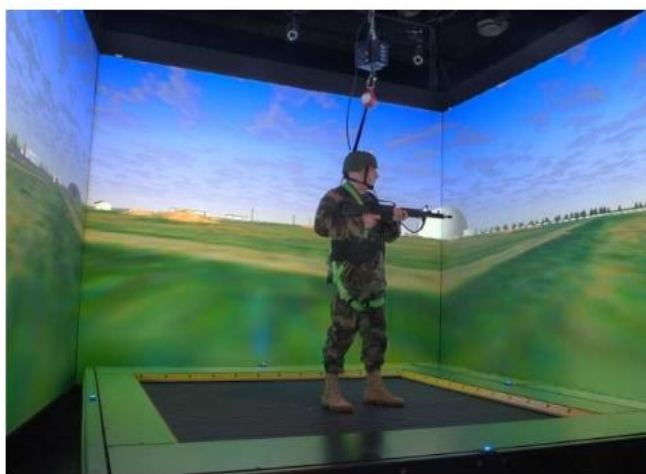
Figura 7. Cinta de correr omnidireccional en un sistema CAVE Fuente: (LaValle, 2017)
