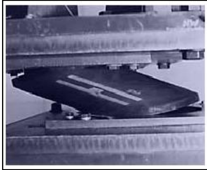
Figura 1.5 Prueba del aislador usado en el edificio Foothill Communities Law and Justice Center.
