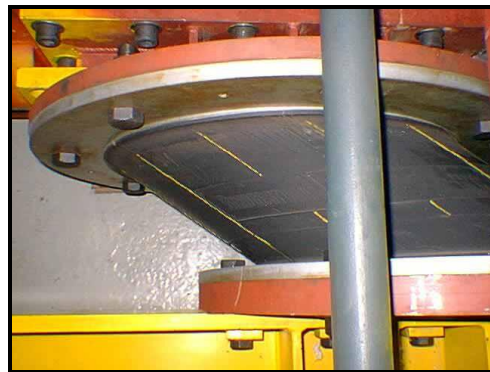
Figura 1.15 Ensayo de un Aislador en el Laboratorio de Dinámica Estructural de la Universidad Católica
