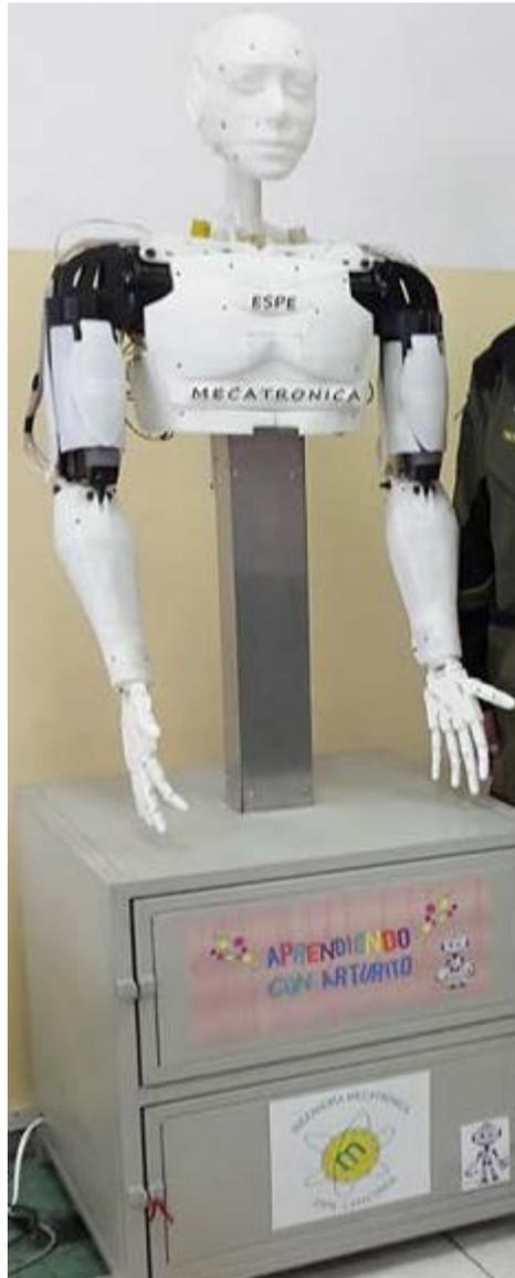
**Figura 3. 30: Ensamble final del robot humanoide**
