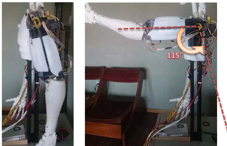
**Figura 4. 6: Prueba movimiento de flexión y campo de operación del brazo**
