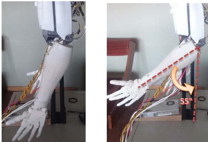
**Figura 4. 4: Prueba movimiento y campo de operación del antebrazo**
