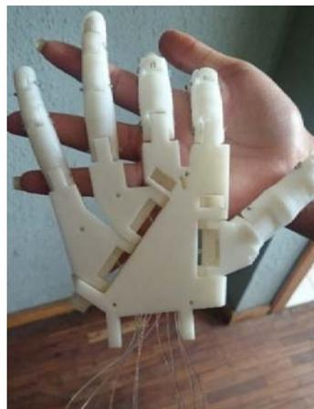
**Figura 3. 10: Ensamblaje de cuerdas de la mano**
