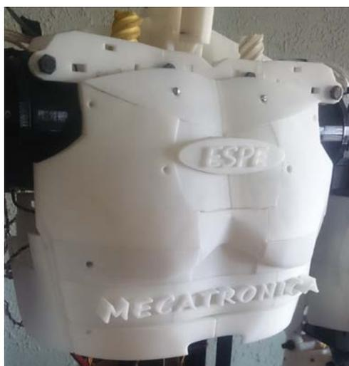
**Figura 3. 29: Ensamblaje físico de tapas del torso**
