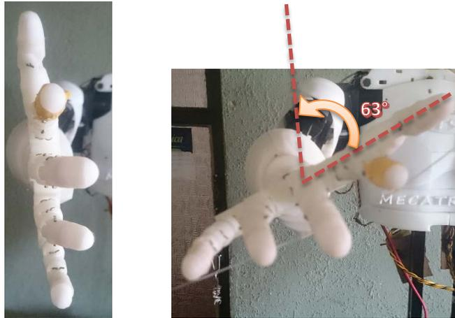
**Figura 4. 3: Prueba de movimiento y campo de operación del dedo**
