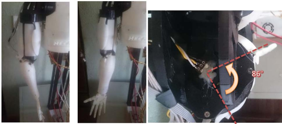
**Figura 4. 5: Prueba movimiento rotación y campo de operación del brazo**
