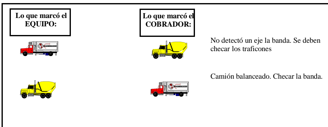
Figura 3.10: Esquema que muestra errores detectados por el equipo a causa del balanceo.
