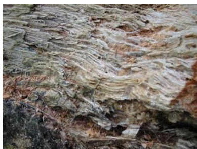
Figura 23 Presencia de hongos xilófagos, pudrición blanca
