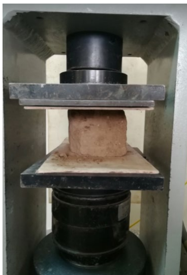
Figura 131 Ladrillo de adobe en la máquina de compresión
