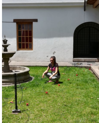
Figura 62 Tendido de cable de conexión de geófonos.
