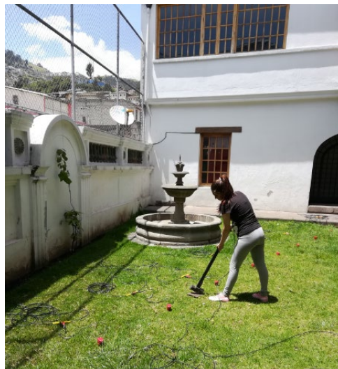
Figura 63 Generación de la energía sísmica, mediante martillazos sobre placa metálica.
