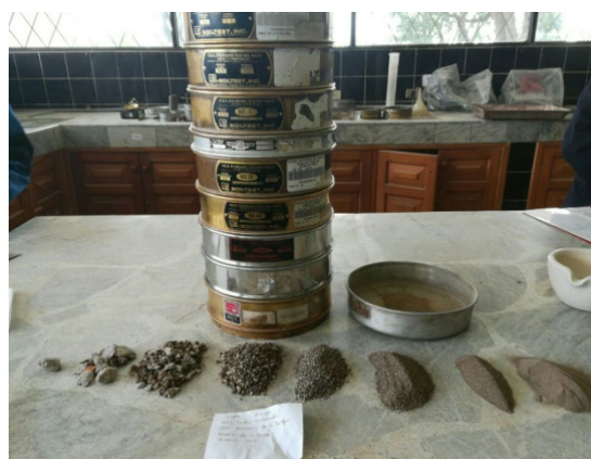
Figura 91 Arreglo de tamices utilizados, muestras retenidas en cada tamiz, SPT 1
