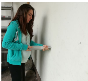
Figura 125 Ensayo de esclerometría en pared de adobe
