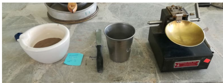
Figura 98 Equipo y muestra utilizada para el ensayo de límite líquido muestra SPT 1
