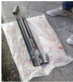
Figura 78 Cuchara partida o toma muestras cilíndrico
