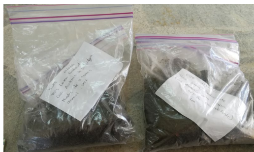
Figura 82 Muestras de suelo obtenido en el ensayo de la Casa de la Academia de la Lengua, colocadas en doble funda cada una, con su respectiva tarjeta de identificación.
