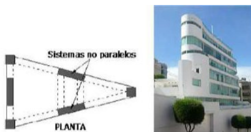
Figura 152 Irregularidad en planta: ejes estructurales no paralelos
