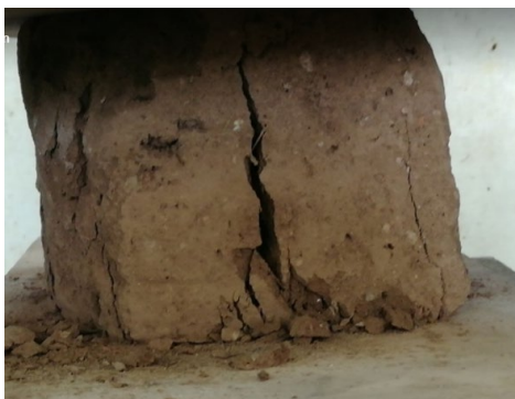
Figura 132 Tipo de falla del ladrillo de adobe ensayado
