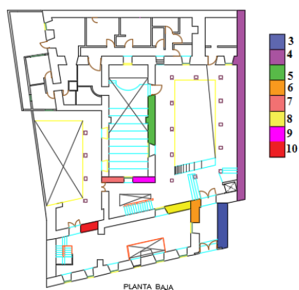
Figura 127 Elementos ensayados con esclerómetro planta baja
