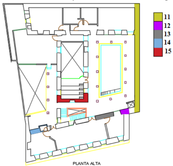
Figura 128 Elementos ensayados con esclerómetro planta alta
