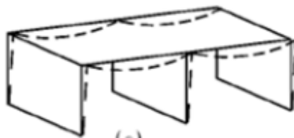
Figura 181 Comportamiento sistema de piso flexible
