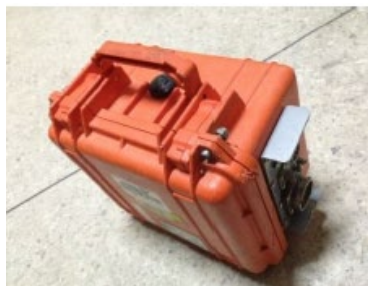
Figura 54 Sismógrafo Modular de 12 canales, Geometrics ES 3000.
