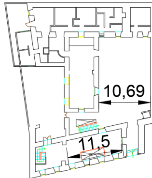
Figura 161 Configuración de muros transversales
