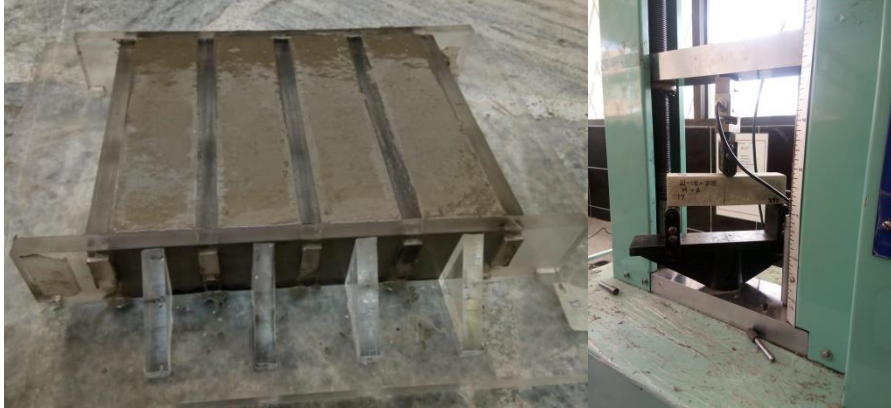
Figura 60 Muestras de mortero en moldes y ensayo a flexión
