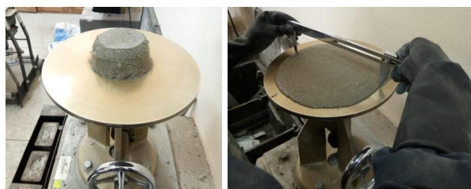
Figura 1 Probeta antes y después del procedimiento de ensayo de consistencia
