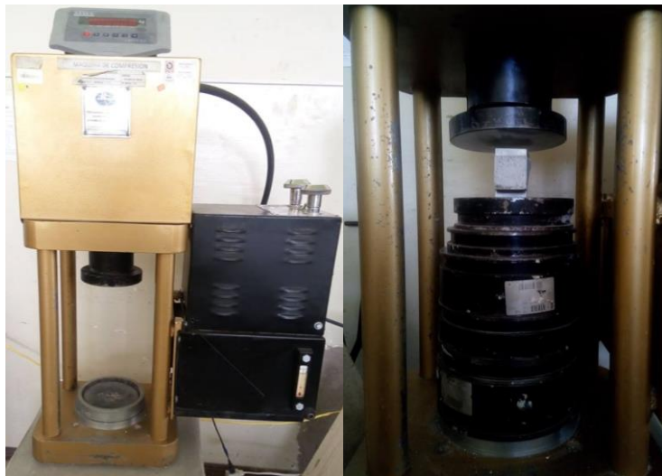
Figura 50 Máquina de ensayo de resistencia a la compresión
