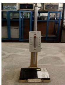
Figura 29 Aparato Vicat para el ensayo de consistencia normal del cemento
