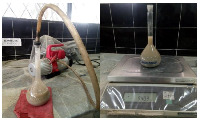
Figura 18 Bomba de vacío y picnómetro con cerámica y agua
