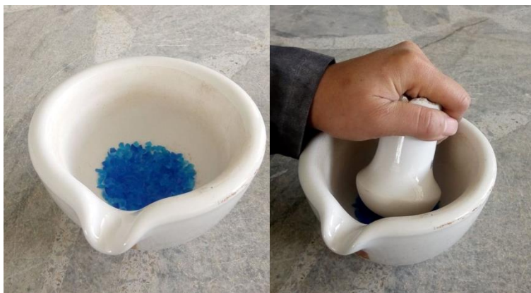
Figura 35 Trituración de Silica gel de tamaño comercial
