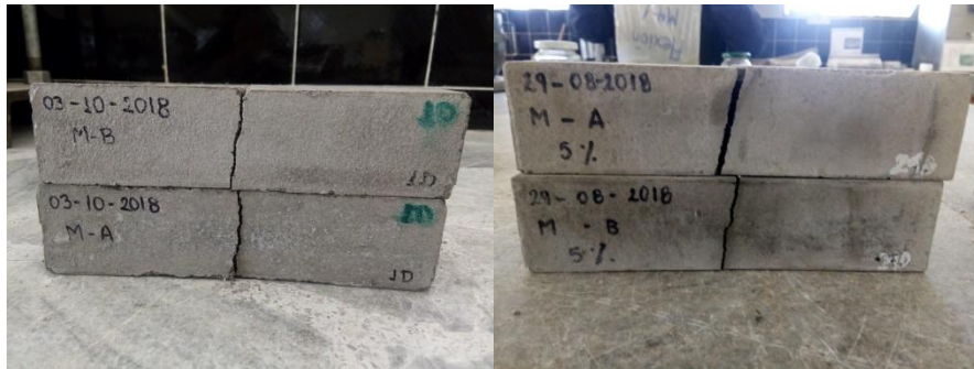
Figura 61 Probetas después del ensayo a flexión
