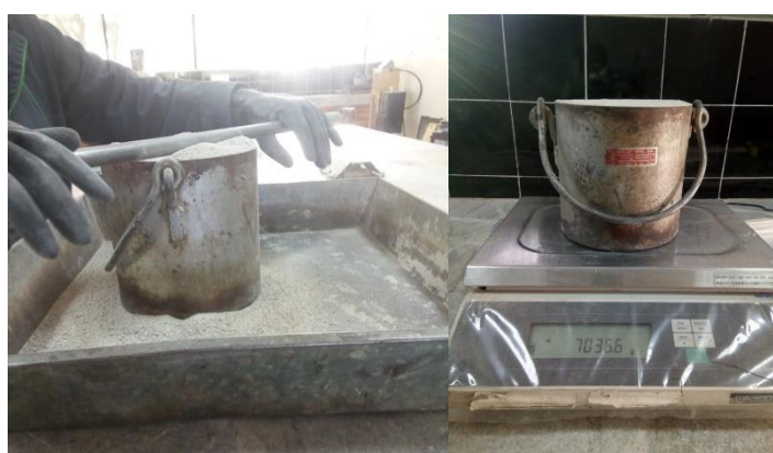
Figura 25 Enrazado y peso de la muestra varillado
