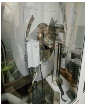
Figura 27 Equipo para ensayo XRD
