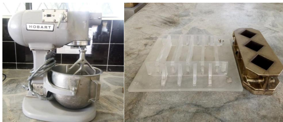
Figura 47 Máquina mezcladora y moldes
