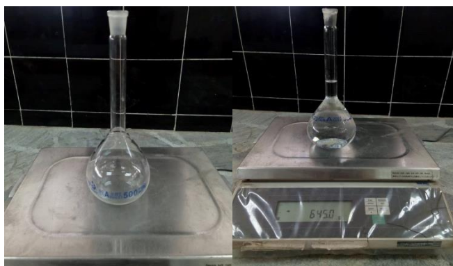
Figura 17 Picnómetro vacío y con agua
