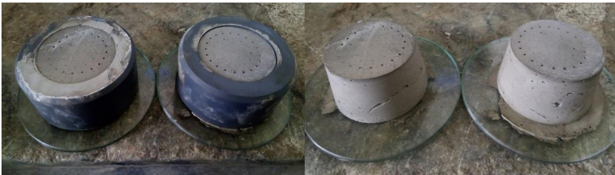
Figura 33 Muestras ensayadas para determinar el tiempo de fraguado
