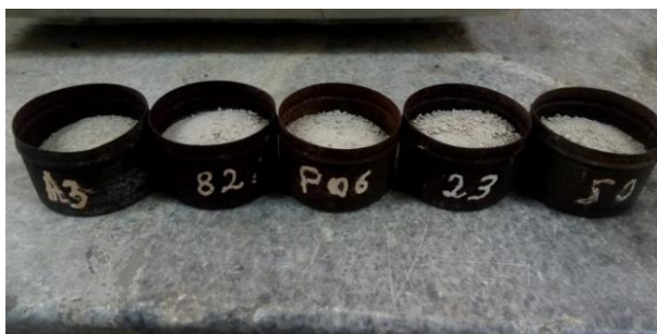
Figura 21 Muestra de árido húmedo
