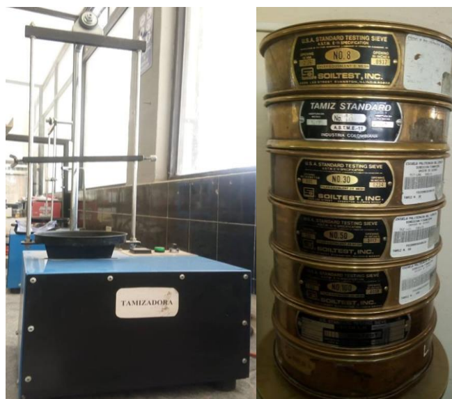
Figura 11 Tamizadora eléctrica y tamices
