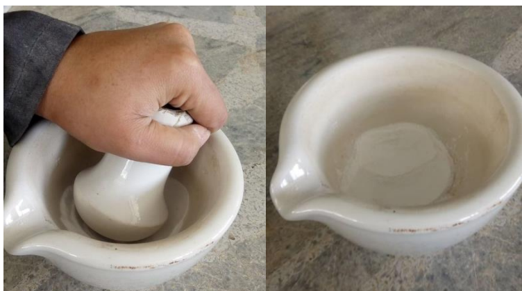
Figura 36 Proceso de triturado de Silica gel
