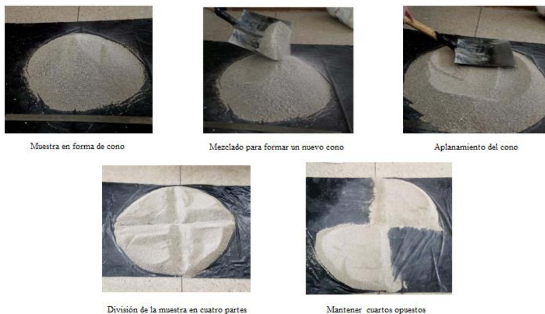
Figura 10 Cuarteo de la muestra de cerámica sanitaria triturada
