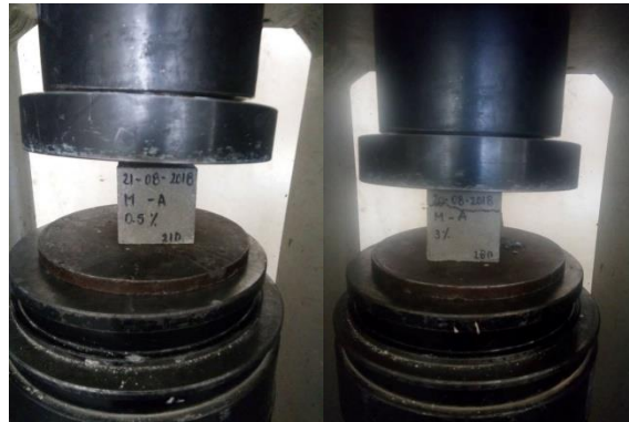
Figura 5 Máquina de compresión
