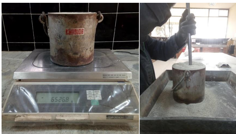
Figura 24 Peso suelto de la muestra y varillado
