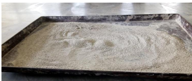
Figura 12 Muestra de material para granulometría
