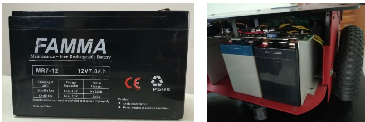
Figura 4. Baterías eléctricas recargables de Plomo Ácido
