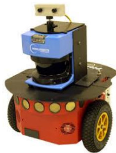
Figura 20: Plataforma equipada con Cámara, Scanner Laser y SONAR
