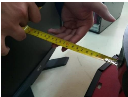
Figura 25. Toma de medida desde el sonar hasta superficie plana
