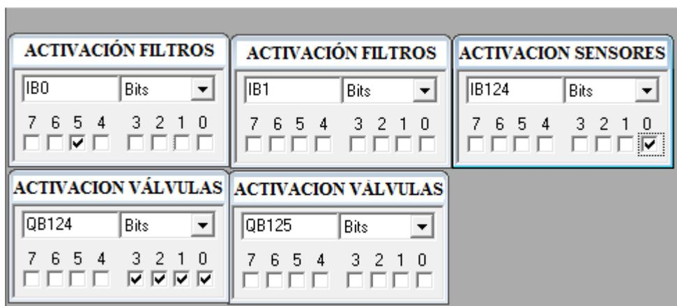
**Figura 68.** Simulación de la etapa de Retrolavado en el simulador S7 – PLCSIM
