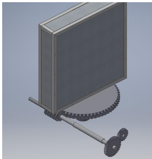
Figura 27. Mecanismo base giratoria concepto 1
