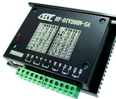
Figura 98. Driver HY-DIV268N-5 a Fuente: (Electronilab, s.f.)
