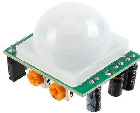
Figura 103. Sensor PIR con lente fresnel Fuente: (Adafruit learning system, s.f.)
