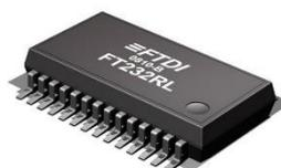
**Figura 38.** Conversor FTDI FT232RL-REEL tipo SMD
