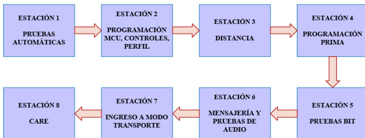
**Figura 1.** Estaciones del proceso de ensamblaje del Sistema Chevystar.
