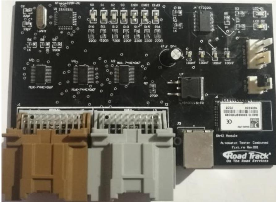
**Figura 91.** Vista frontal de la placa electrónica secundaria.
