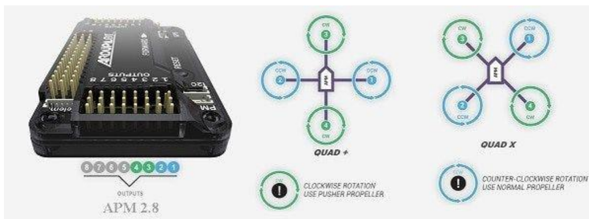
Figura 28. Esquema de las configuraciones tipo QUAD + y QUAD X.
