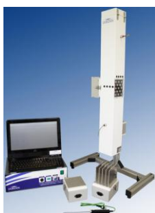
Figura 3 IT 03.2 Transmisión de calor por convección natural y forzada
