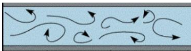
Figura 19 Representación de movimiento aleatorio de partículas de un fluido en un flujo turbulento.
