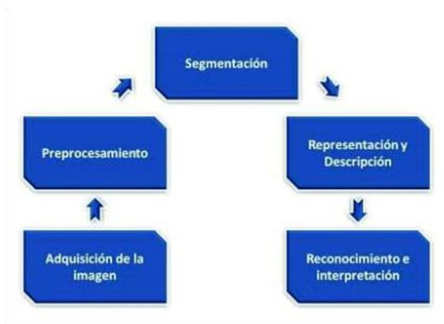
Figura 23. Etapas de un sistema de visión artificial Fuente: (Cantero & Martínez, 2016)
