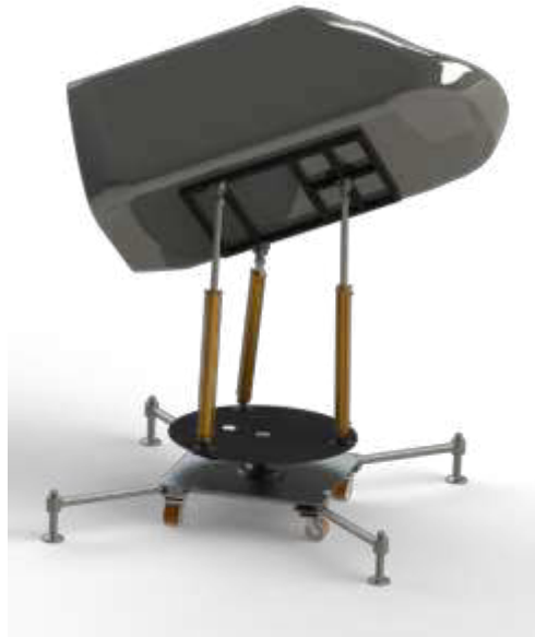
Figura 15. Diseño de la Estructura Mecánica del Prototipo
